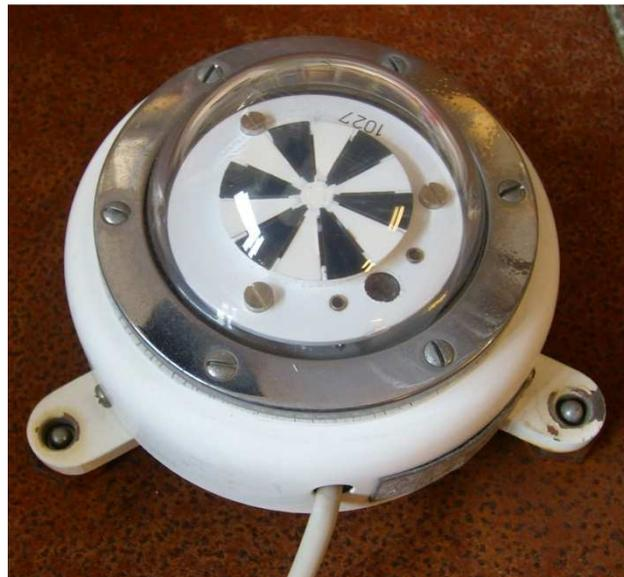
**Figure 9.2.1.4: Pyranometer Wilh. Lambrecht Kg**
