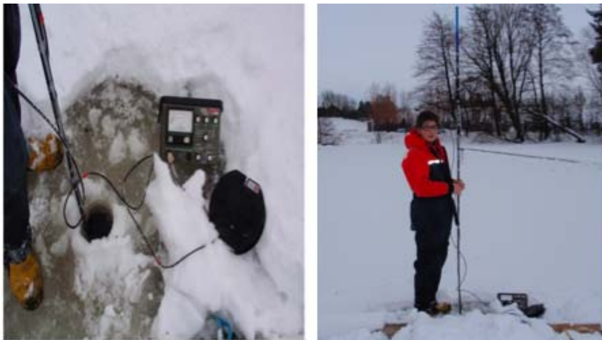
Figur 5.2 a) billeder til venstre viser hullet i isen ved station 3, hvor teleskopstangen med påspændt iltelektrode samt slange til prøvetagning måler i vandfasen under isen. Ved siden af hullet ses iltmåleren. b) billedet til højre viser hele opstillingen.
