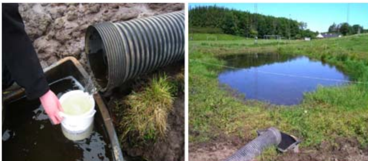
Figur 5.3 a) til højre ses den lille dam vest for boldbanerne, hvortil afstrømningen fra landbrugsarealerne vest for dammen tilløber. Nederst i billedet ses røret hvorfra overfladevandet strømmer til dammen. I baggrunden ses den øverste dræuede del af boldbanerne. b) til venstre ses udløbet til dammen. Der ses desuden hvordan vandføringen af overfladevandet fra landbrugsarealerne blev målt .
