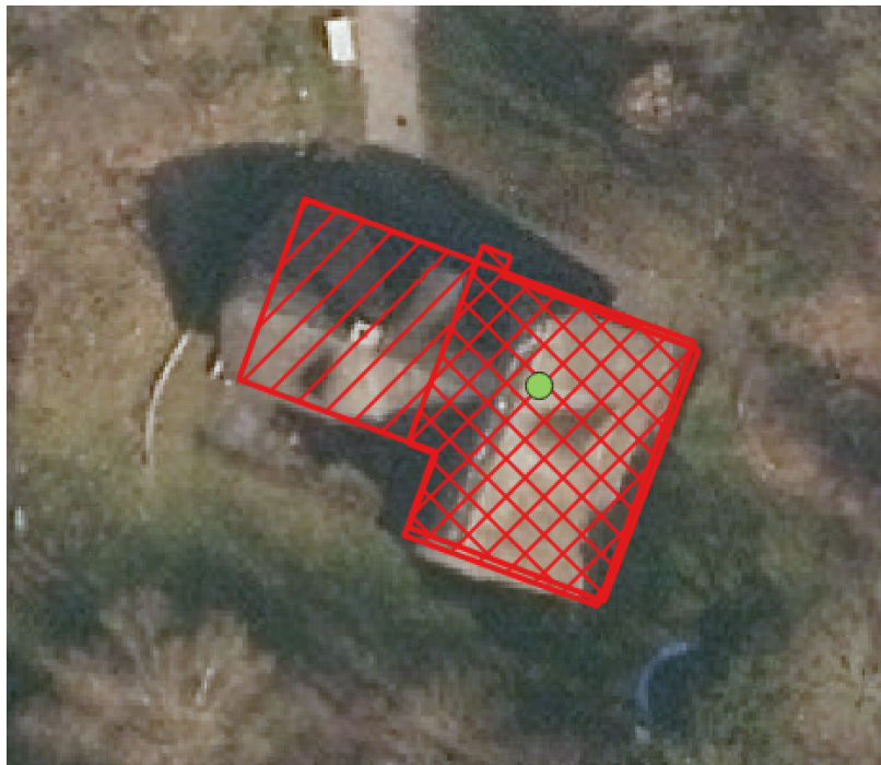
Figur 8.4: Et punkt ligger inden for to bygningspolygoner, som er skruet med rødt.
