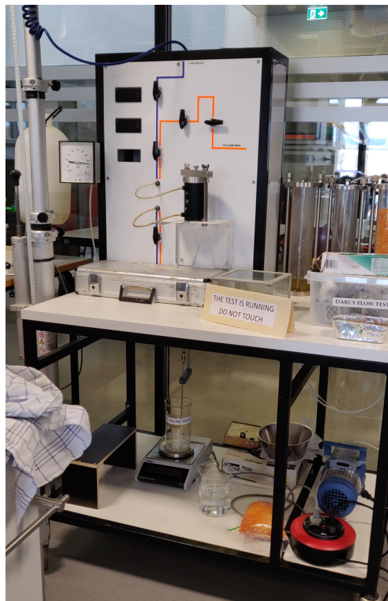
Figur 4.3. Billede Darcy opstilling.
