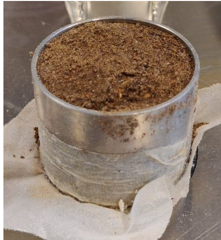
Figur 4.9. Billede af prøve 1,2, hvor det kan ses cylinderen ikke er fyldt med jord, og derfor giver afvigelse i resultater.
