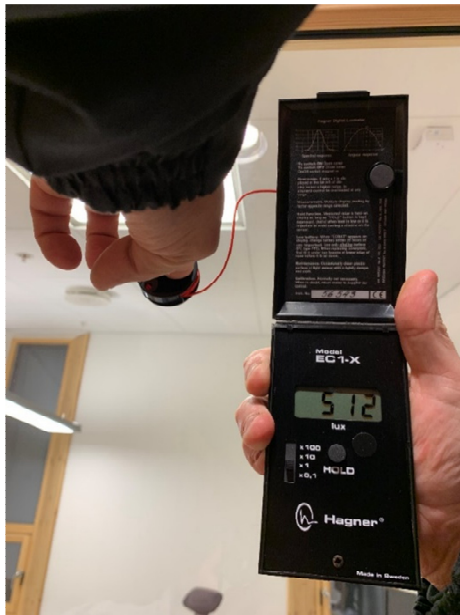
Foto viser luxmeter som viser antall lux som slippes gjennom glasset.
