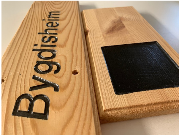
Foto viser utfreste bokstaver på skilt, hvor fargen gjentas på en større fargeprøve for måling.
