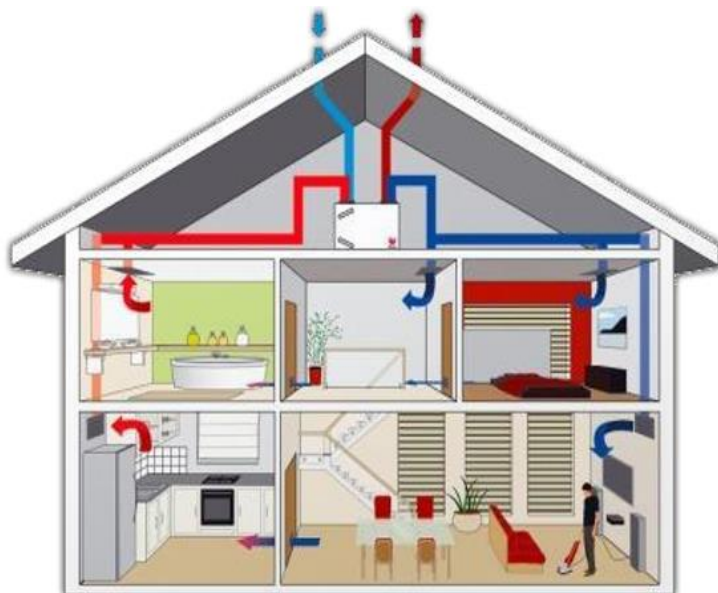
Figur 57 - Mekanisk balanceret ventilation. Figur taget fra undervisningsmateriale.
