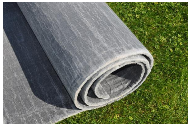
Figur 5: Spaceloft 10 mm fra Aspen Aerogels i måtteform
