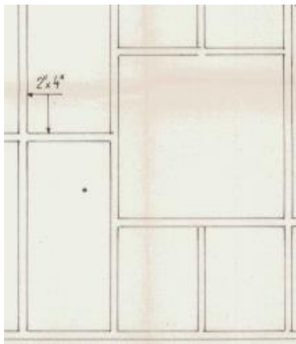
Figur 92: Træskeletvæg ved vindue i gavl af parcelhus i halvanden plan fra 1972 (Fløng)
