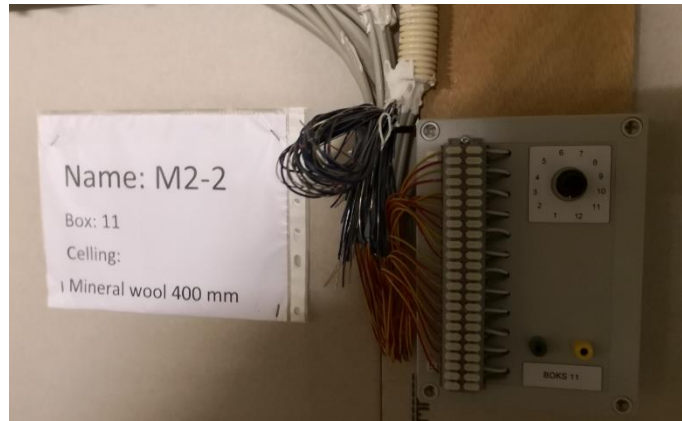
Figur 45: Målepunkt for Træfugt i stueplan. Her for tagrum M2.2.
