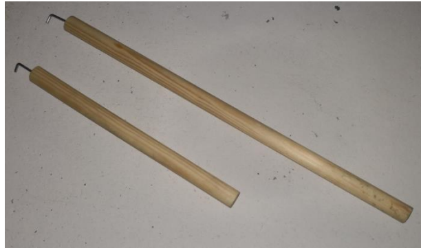
Figur 38: Hjemmebyggede monteringspinde var nødvendige da rørisoleringen nemt kunne blive presset for langt ned eller skulle skubbes på plads.
