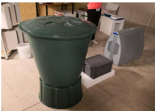
Figur 20: Befugteren er tilsluttet en mindre vandbeholder med en flyder, som styrer vandtilførsel fra den store vandtank. Den store tank opfyldes manuelt en gang om ugen.
