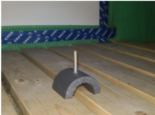
Figur 8: Sporgaskilde, grå/silver, med sporgassen PMCP. Her placeret centreret i tagrum i testhuset. Rørskålen viste sig at være godt egnet som holder til sporgaskilden.
