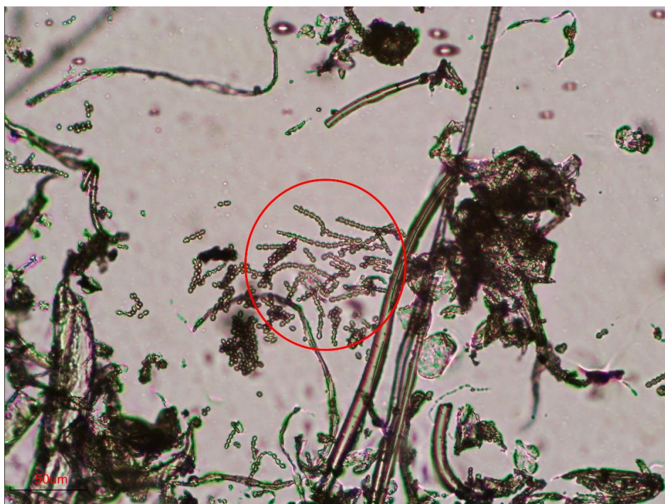
Figur 80: M3.5 efter forsøgsperioden. (x200). Den røde cirkel viser tydeligt skimmelsvampe strukturer. Disse er umiddelbart ikke samme familie som i M2.4, men der er flere strukturer at se. Prøve taget d. 24.04.2019.
