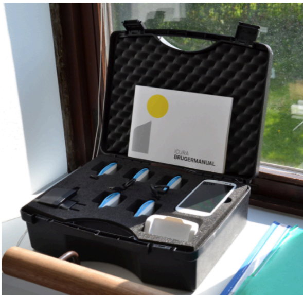
Figur 6: iCura trainers hardware i kuffert bestående af smartphone, fem bevægelsessensorer, en stander, brugervejledning samlet opladerløsning til alle sensorer.
