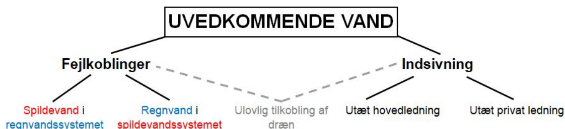
Figur 1.1: Konceptuel model over typer af uvedkommende vand i kloaksystemer.
