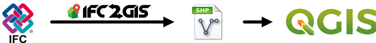
Figur 8-2: Diagram, som viser processen i projektets løsningsforslag, set fra en brandteknisk sagsbehandlers arbejdsproces ved eksport af informationer til en GIS-baseret platform. Figuren er baseret på buildingSMART (2018c) og QGIS (2018b).
