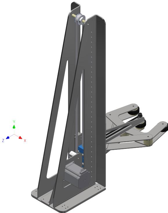
Figur 9.14: Gribemekanismen monteret i elevatorsøjlen.
