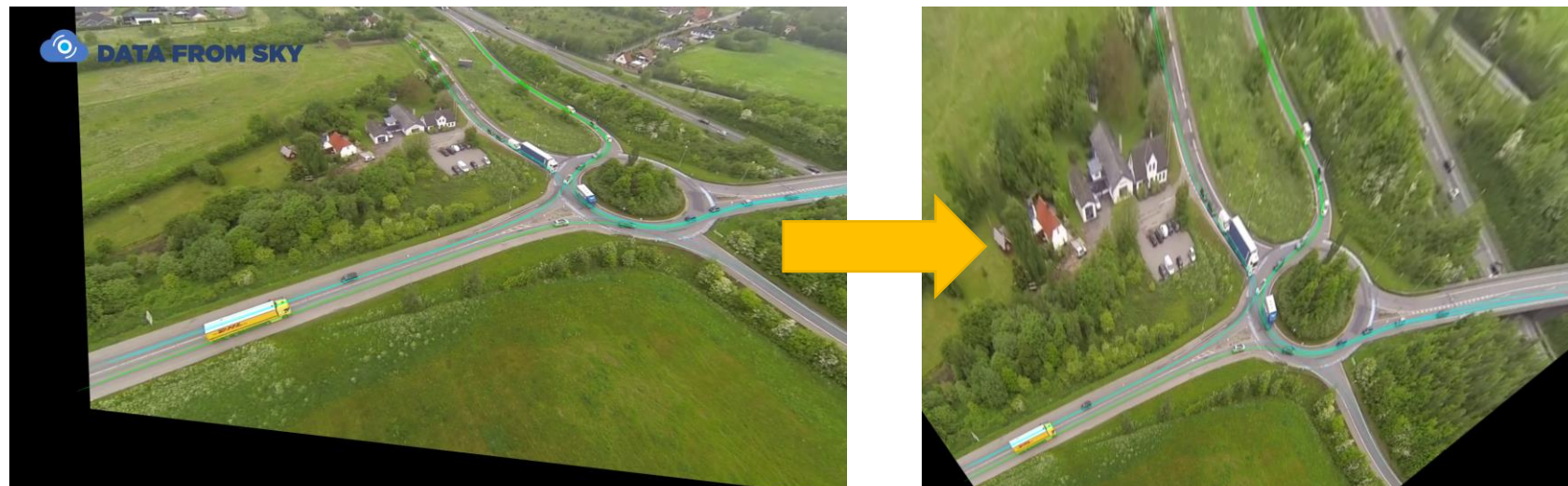
Figur 2-2 Proces for "vridning" af videooptagelse ned i planet. Venstre billede viser stabiliseret dronevideo, højre billede viser samme billede blot vredet ned i planet.
