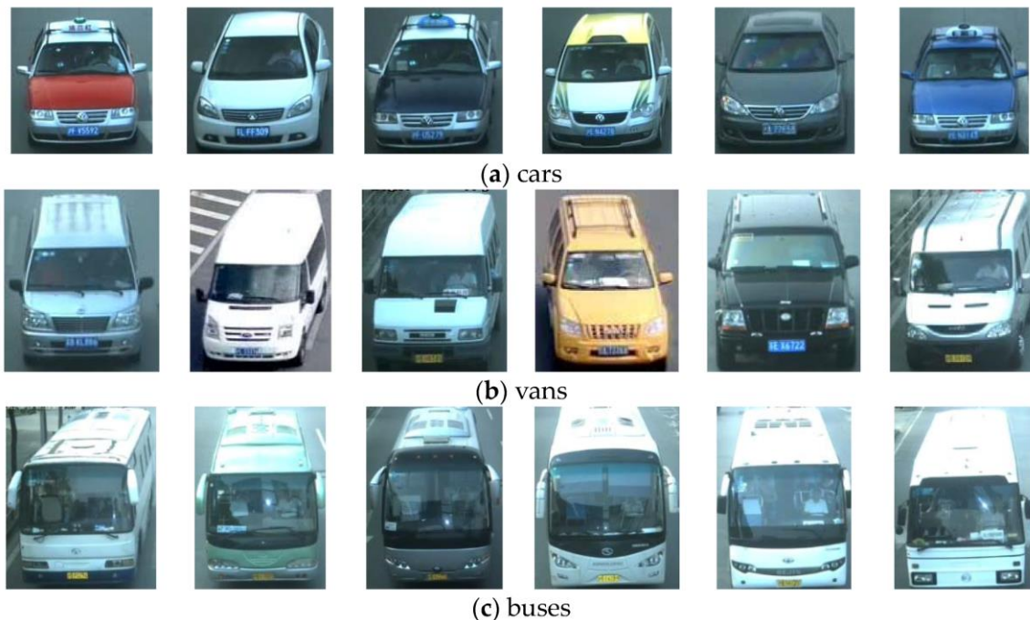
Figur 2-3 Et eksempel på et testset til automatisk klassificering af køretøjer set forfra. I DataFromSky benyttes trafikanter fra flere vinkler, for at få et større testset og dermed en større nøjagtighed. Figur hentet fra (Qin, Huang and Chen, 2017).
