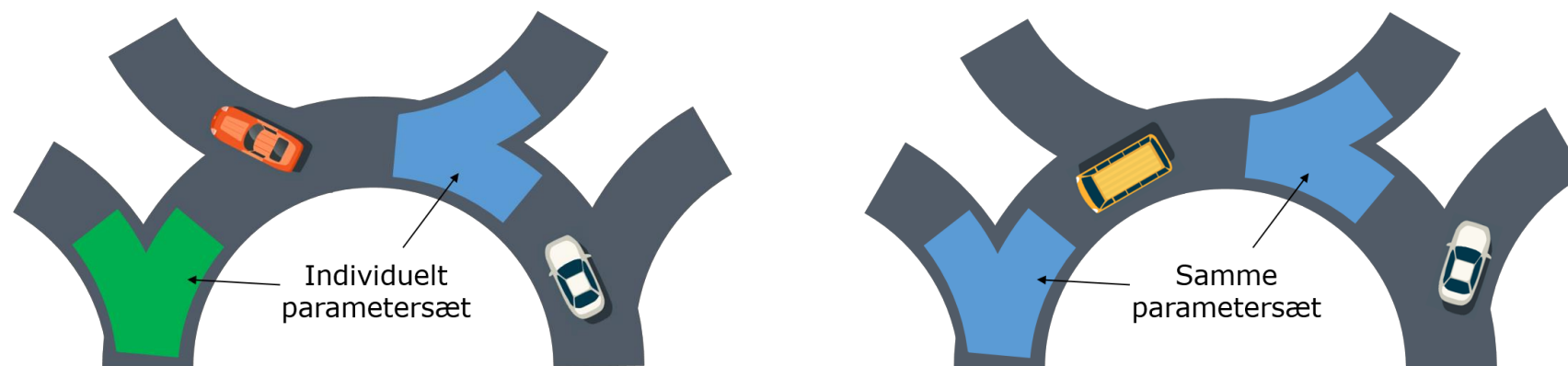
Figur 4-1 Principskitse af Conflict Areas i VISSIM med henholdsvis individuelle parametersæt og ét samlet parametersæt.
