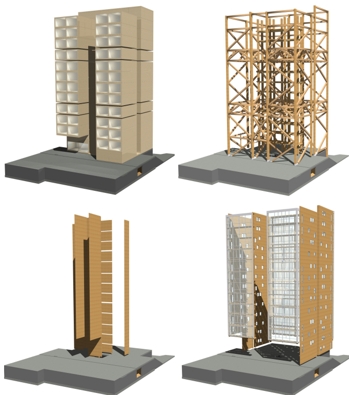
Figur 5.6: Komponenterne, som Treet består af. Øverst til venstre ses modulerne, mens rammekonstruktionen af limtræ er vist til højre for. Nederst til venstre ses de anvendte massivtræs-elementer, mens facadebeklædningen er vist til højre for. [Trifkovic, 2015]
