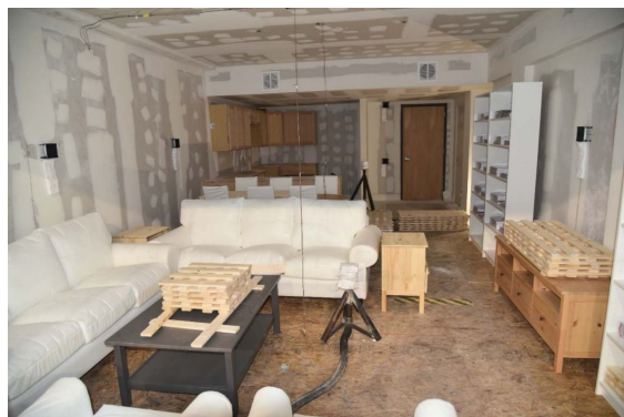
Figur 2.14: Møblering af stue til brandforsøg set fra front. [Zelinka et al., 2018]
