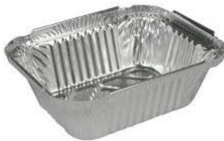
Figur 35: Aluminiumsbakke som benyttes som fugthætte til måling af fugt i materialelag.
