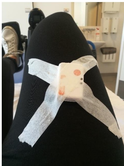
Figur 3: Shimmer3 placeres på låret, med den orange krop distalt fra kroppen
