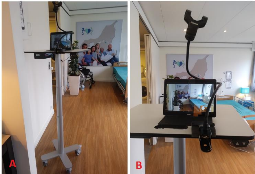
Figur 4.11: A og B: Forsøgsopsætning til optagelser af forsøgsdeltagernes udførelse af forflytninger.
