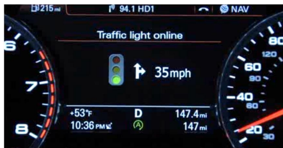
Figur 1.13: Udsnit af Audis digitale instrumentbræt, hvor GLOSA-funktionen er aktiv og informerer føreren om den optimale hastighed frem mod et signalreguleret kryds. [SWARCO, 2015]
