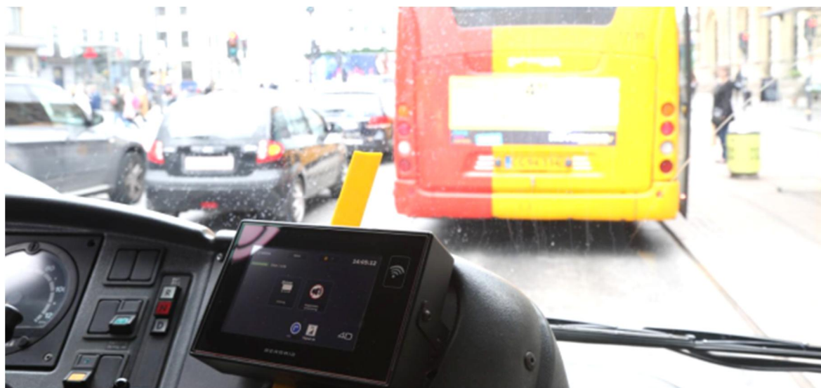
Figur 1.12: Compass4D kommunikationsenhed i en bus på rute A1 i København, hvor buschaufføren via enheden præsenteres for række forskellige informationer som udveksles via V2I kommunikation. [Københavnskommune 2016]
