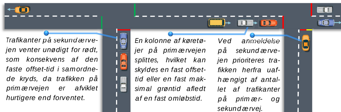
Figur 1.16: Principsskitse, som illustrerer situationer på en strækning med flere samordnede signalanlæg, hvor traditionelle principper, herunder teoretisk beregnede offset-tider samt en fast maksimal grøntid afledt af en fast omløbstid, medvirker til en unødigt ventetid for rødt på såvel primær- som sekundærvej.
