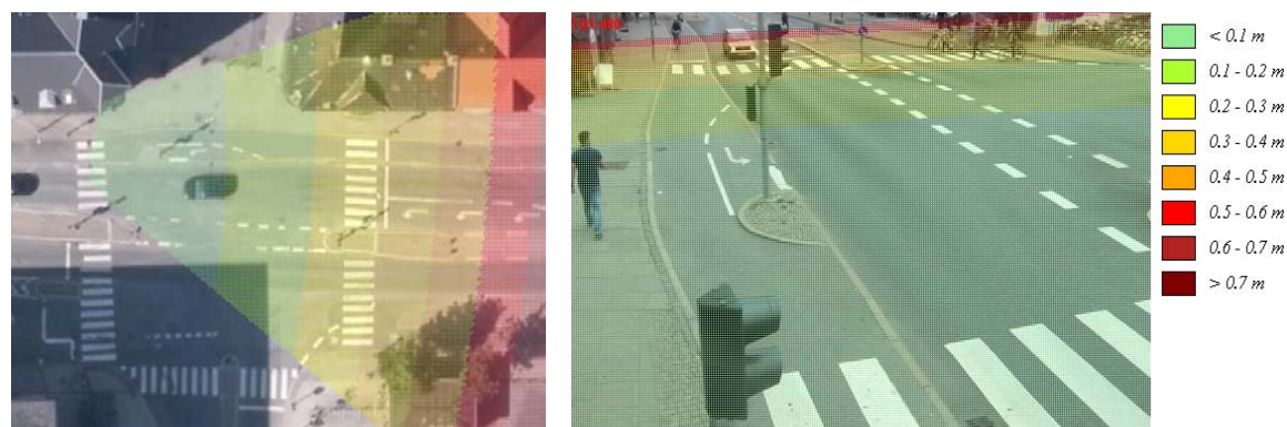
Figur 4.3: Eksempel på T-Calibration-diagram for kameraets nøjagtighed. Diagrammet indeholder et ortofoto af krydset, et billede af videokameraets synsfelt samt fejlmargin illustreret ved en farveskala. (Trafvid, 2015)*
