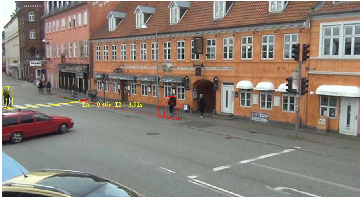
Figur 4.5: Eksempel på "frame-by-frame"-gennemgang af konfliktsituation. Her ses en situation, hvor de to konfliktende trafikanter ikke er på kollisionskurs og derfor beregnes T_{Adv} og T_2 for den pågældende frame.
