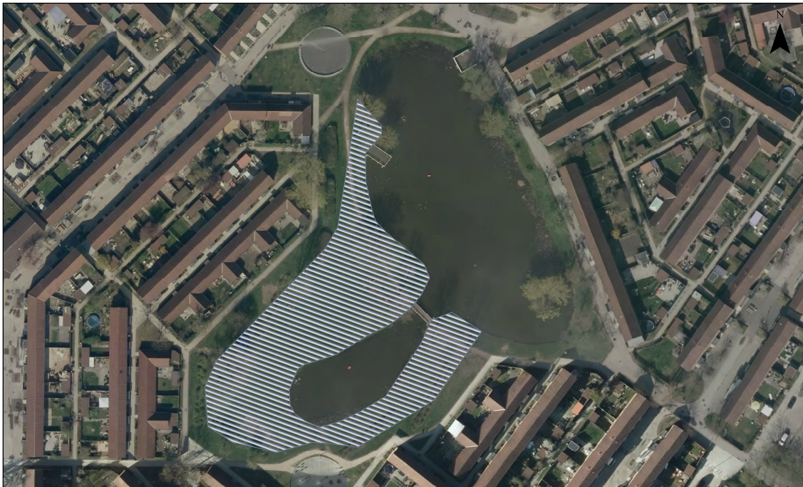
Figur 7.7: Mulighed for udvidelse af gadekæret. Det skraverede areal er ca. 3200 m 2 . Det ekstra volumen er fra kote 2,4, som er det nuværende vandspejl og til kote 3,3, som er koten de omkringliggende huse ligger i.
