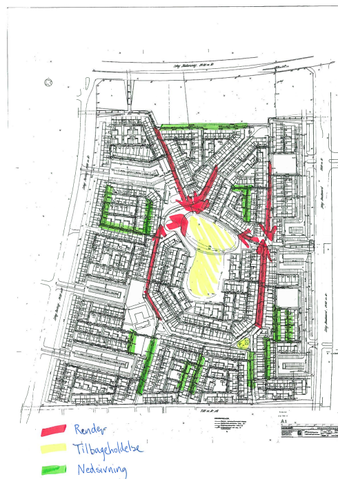
Figur 7.3: Tredje princip for klimatilpasning af Gadekæret: Transport, forsinkelse og nedsivning.
