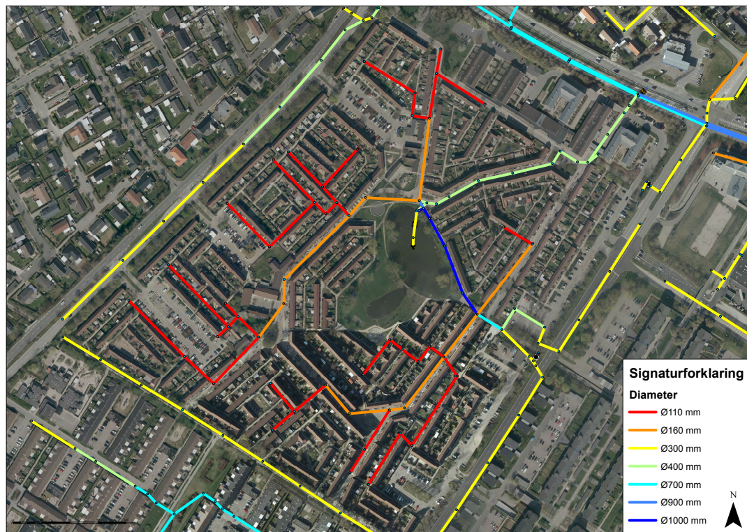
Figur 3.5: Oversigt over ledningsdimensionerne i Gadekæret.
