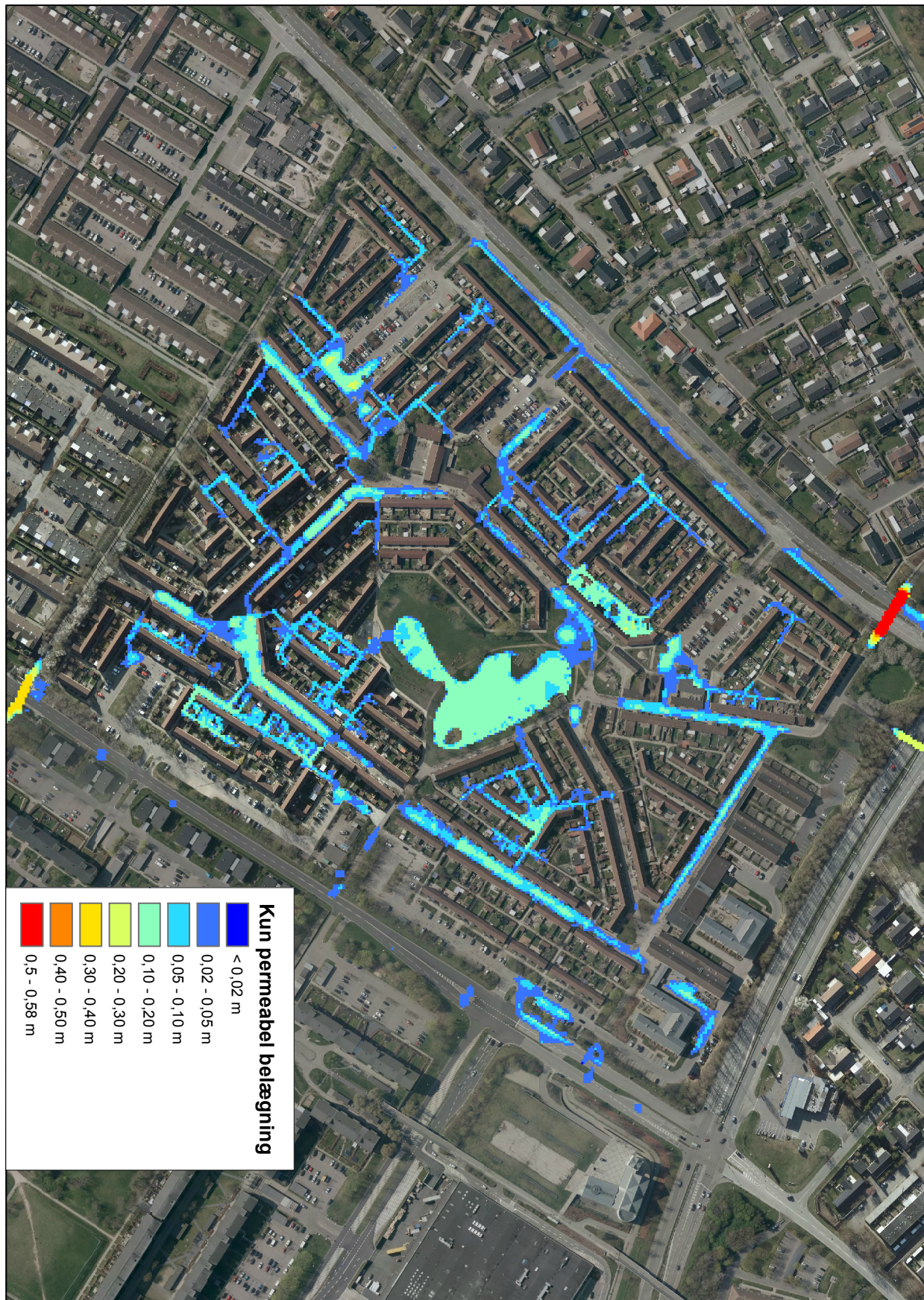
Figur C.1: Maksimal oversvømmelse i Gadekæret ved regnhændelsen d. 2. juni 2014 efter implementering af permeabel belægning, hvor befæstelsesgraden på vejene er ændret fra 90% til 70%. Terrænmodellen brugt i denne simulering har en cellestørrelse på 1,6 m.
