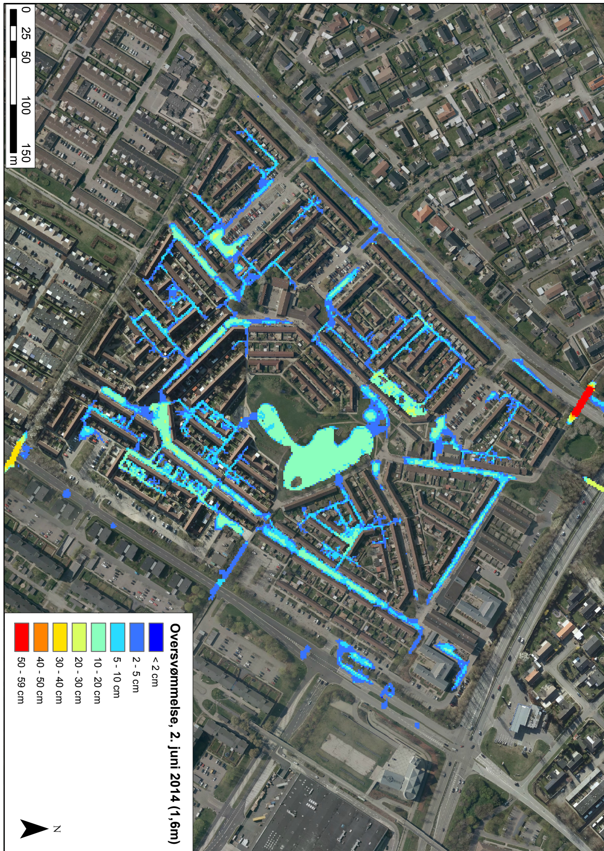
Figur 4.3: Maksimal oversvømmelse i Gadekæret ved regnhændelsen d. 2. juni 2014. Terrænmodellen brugt i denne simulering har en cellestørrelse på 1,6 m.
