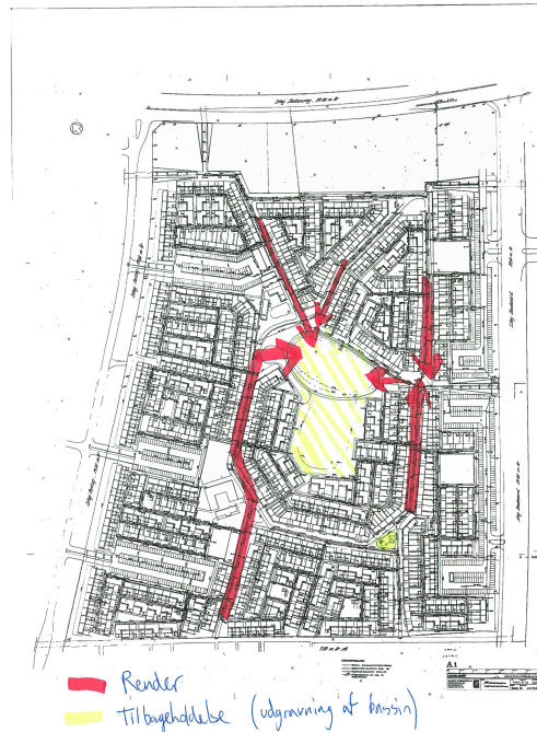
Figur 7.2: Andet princip for klimatilpasning af Gadekæret: Transport og forsinkelse.
