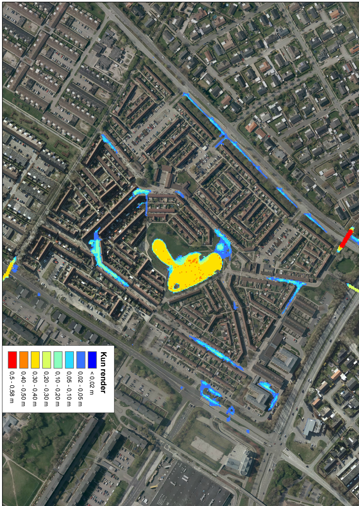
Figur C.3: Maksimal oversvømmelse i Gadekæret ved regnhændelsen d. 2. juni 2014 efter implementering af render i hovedvejene. Renderne er opbygget som en trapez og har en maksimal dybde på 35 cm og en bredde på 120 cm. Terrænmodellen brugt i denne simulering har en cellestørrelse på 1,6 m.
