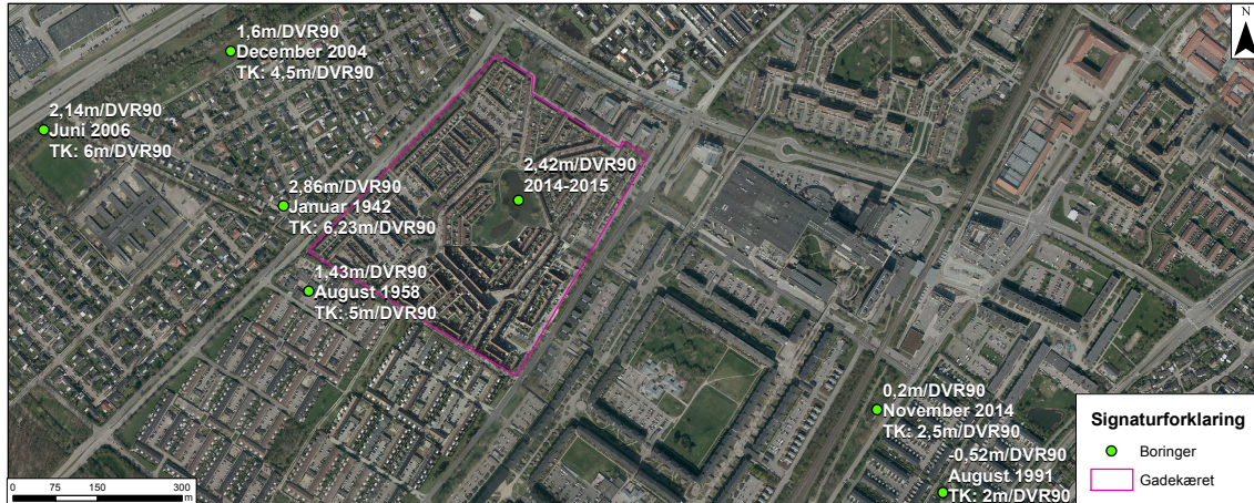
Figur 7.9: Oversigt over boringer omkring Gadekæret samt vandspejlskoten på gadekæret. Hver boring har tre labeltekster. Den øverste er den pejlede kote på grundvandsspejlet. Derefter er datoen for pejlingen. Sidst er Terrænkoten for boringen.
