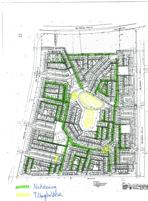
Figur 7.1: Første princip for klimatilpasning af Gadekæret: Forsinkelse og nedsivning.
