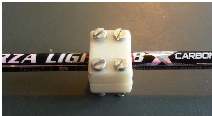
Figur 15. 3D-printet resultat af loddet inklusiv skruer og bolte.
