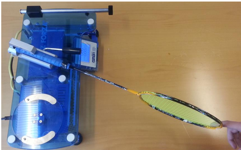
Figur 8. GOSEN GM31 her blev anvendt til at måle ketsjerens inertimoment
