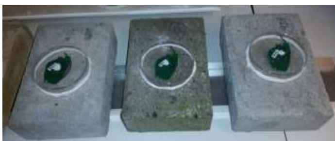
Figur 43. Udtørningsforsøg med 3 betonfliser.
