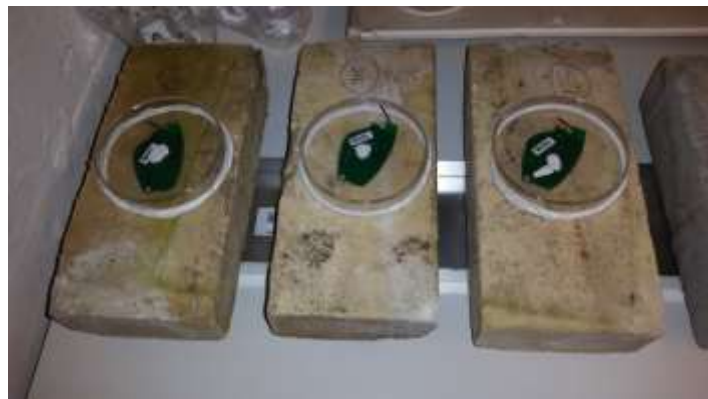
Figur 41. Udtørringsforsøg med 3 mursten.
