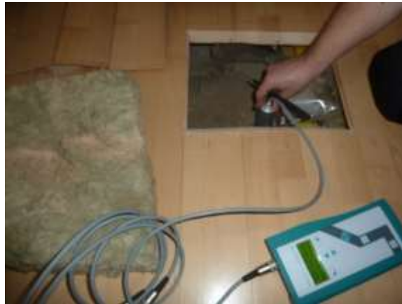
Figur 14. Måling med HF sensor på betonklaplag.
