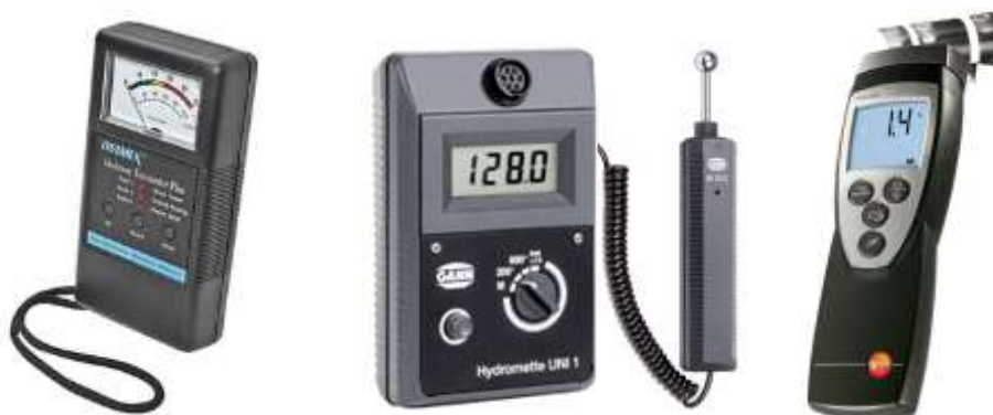
Figur 9. Eksempler på kapacitive fugtscannere. Til venstre en Tramex fugtscanner med pladeføler (Amazon, 2015), i midten en Gann fugtscanner med kugleføler (Svenskatermoinstrument, 2015) og til højre en Testo fugtscanner med bøjleføler (Bønsøe, 2015).
