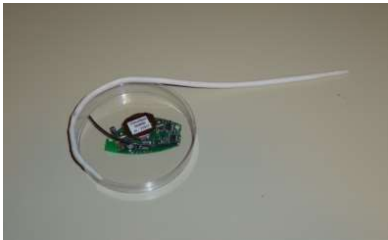
Figur 17. Påsætning af Climaspot sensor med klæbegummi og klæbegummi på petriskål.
