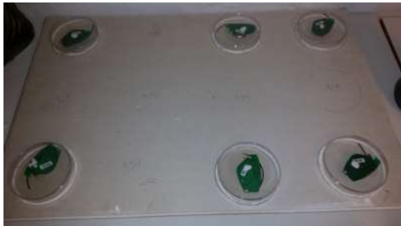
Figur 30. Gipsplade med 6 fugthætter, placeret i laboratorium hos SBMI A/S i Hørsholm.
