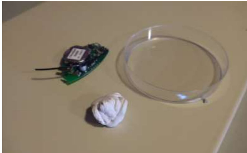
Figur 16. Klargøring af Climaspot sensor. Til dette benyttes plastic petriskål og klæbegummi.
