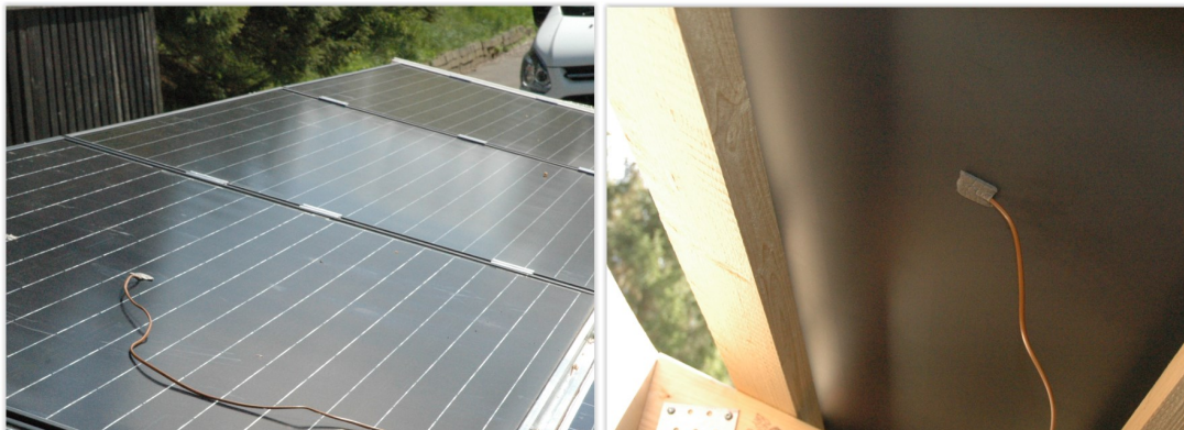
Figur 22, Placering af overfladetemperaturføler på overside celle
