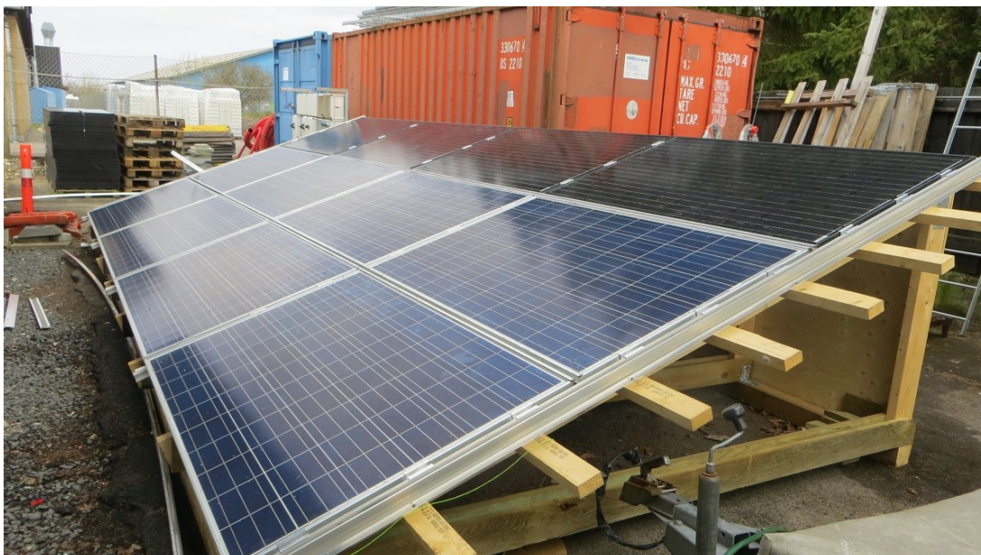
Figur 19, Forsøgsopstilling med solceller på lægter
