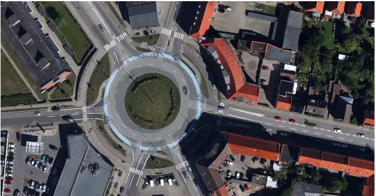
Figur 7: Cirkulationsareal med 2 spor og til- og frafarter med 1 spor - Strandby Plads i Esbjerg
