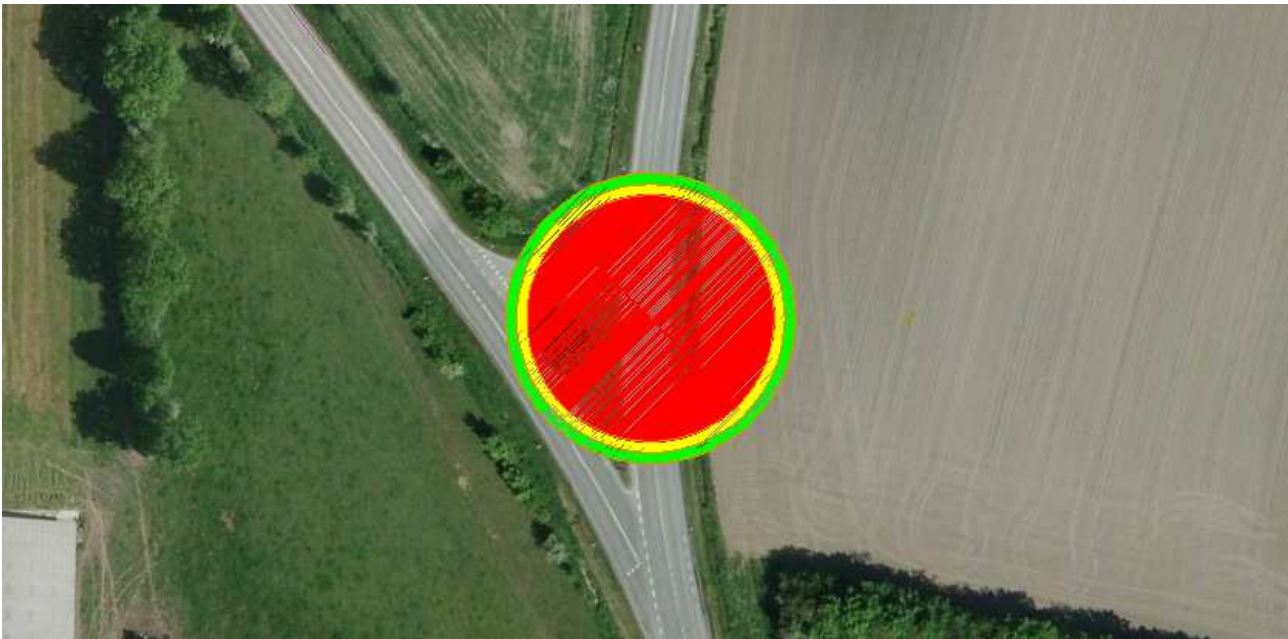
Figur 9: Radius til yderste begrænsningslinje i cirkulationsarealet på 20, 22, 24 meter
