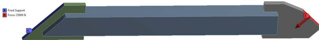
Figur 79 - Den skrå SHS bjælke vist med understøtning og last. (A) viser den faste indspænding. (B) viser den påsatte last.
