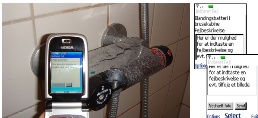
Figur 4-13 Indberetning af fejl via mobiltelefon med NFC-understøttelse. Bygningsdel scannes for RFID-tag, link i det indlejrede RFID-tag refererer til den korrekte indberetningsformular. På baggrund af stamdata om bygningsdel, fejlbeskrivelse og evt. vedhæftet foto kan D&V-organisationen igangsætte korrekt og effektiv fejludbedring.
