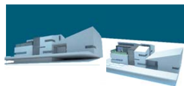
III. 315. Facade og snit 1:400. Istedet for at have tilbygningens tag, til at hælde nord-syd, er der lavet forsøg med at hælde taget øst-vest. Med denne mulighed, kommer tilbygningen til at virke meget dominerende, og kommer op på højde med boligen.
