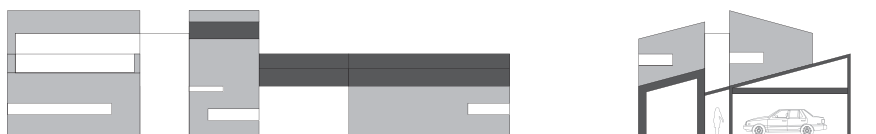
III. 312. Facade og snit 1:400. Taget på facaden imod syd er vendt, så facaden på tilbygningen imod syd bliver mindre, hvilket gør at taget på tilbygningen fra syd bliver lidt mere synlig.
