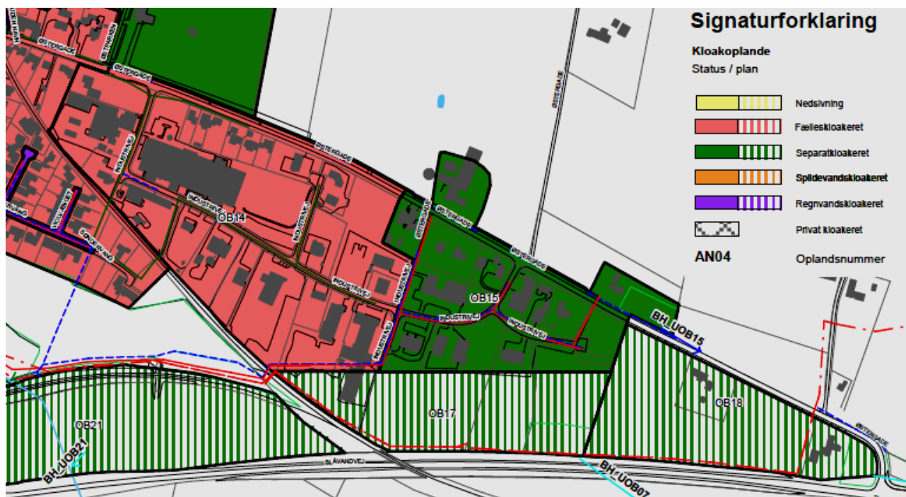
Figur 3: Viser fordelingen af fælleskloakerede og separatkloakerede oplande i Oksbøls erhvervsområde jvf. Varde Kommunes spildevandsplan. For større version af kortet se bilag 1
