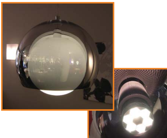
ill. 22: Her ses en af de mange LED lamper fra Zumtobel. Lampen lyser ved hjælp af et LED modul bestående af seks LEDs.
