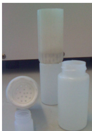
Figur 29. Filtreringsrør brugt til udskillelse af porevand fra vådt sediment under centrifugering.
