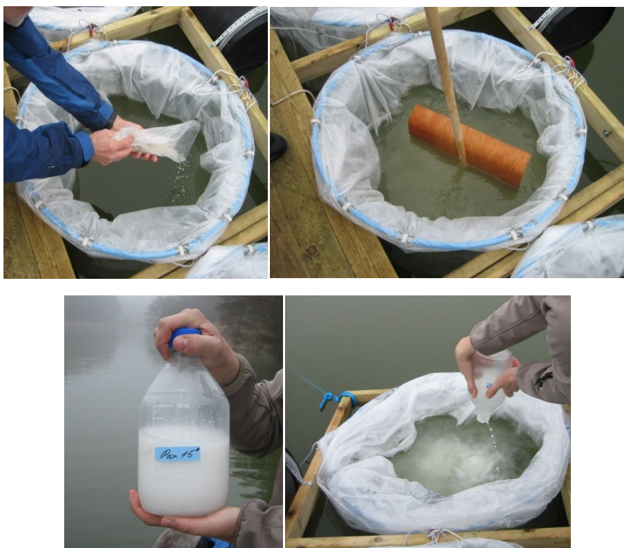
Figur 10. Øverst til højre bliver Phoslock™ doseret i granulatform til en mesokosmos og umiddelbart efter tilsætningen blev det øverste af vandsøjlen omrørt vha. en sneskraber. Nederst er der et billede af det pH-justeret PAX-15 før og under tilsætning. Vandsøjlen blev også omrørt efter tilsætning af PAX-15.
