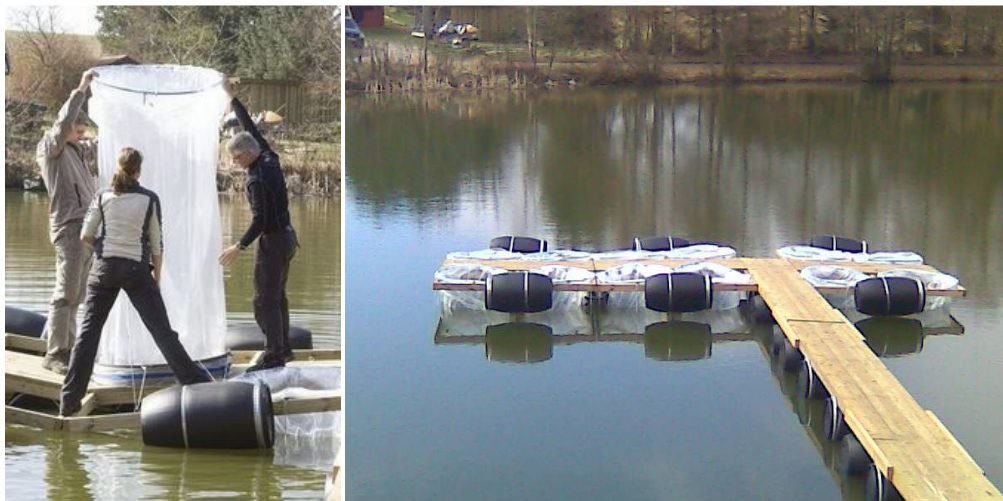
Figur 9. Til venstre er der et billede af en mesokosmos, inden den blev sænket ned i søen. Ved nedsænkning af mesokosmerne blev det antaget, at jernringene borede sig ned igennem de øverste ~15 cm porøse sediment og dermed fæstnede sig selv til bunden. Hver mesokosmos udgjorde 0.8 m 2 og havde en dybde fra 1,2 til 1,35 m og var alle fæstnet til gangbroen (egne billeder og Nordjyske Stiftstidende, 2009).
