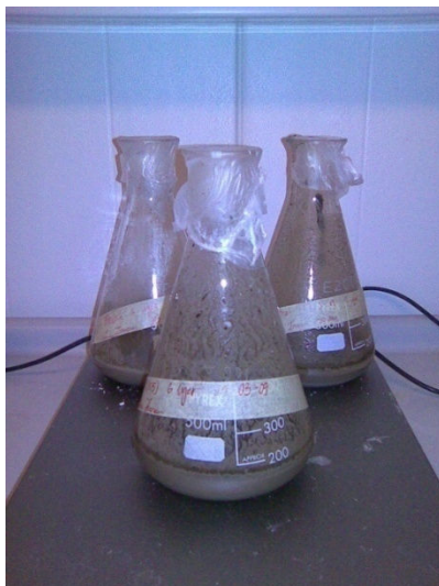
Figur 36 Kolber med en slurry bestående 50 g vådt sediment, 50 mL kunstigt søvand og enten PAX-15 i koncentrationen 50 g Al/m 2 eller Phoslock™ i koncentration 400 g/m 2 eller helt uden fældningsmiddel. Prøverne står på en magnetomrører i et kølerum, der konstant er på ~5 °C. Kolbens åbning er dækket med parafilm, så der ikke fordamper vand fra prøven, men så der stadig er iltgennemtrængning til kolberne.
