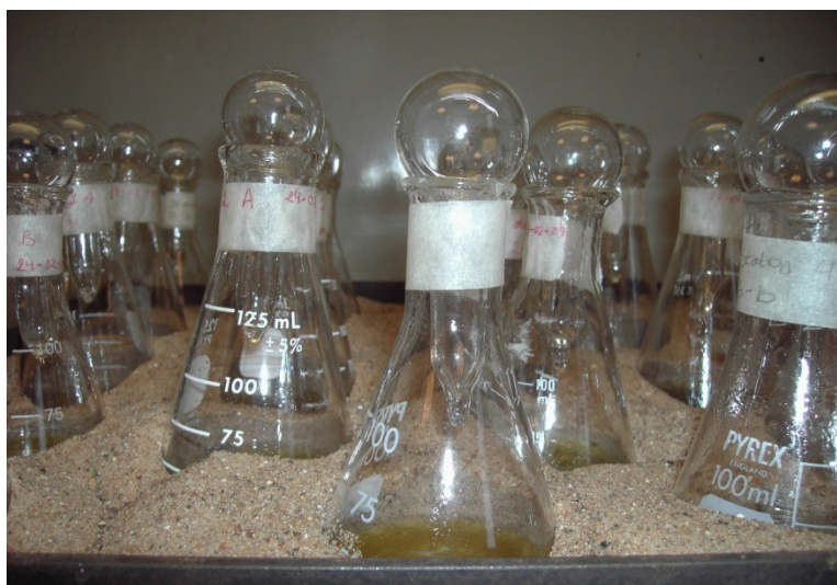
Figur 32. HCl ekstraktion til bestemmelse af P_{total} i 1 g gløderest vha. af kogning af prøverne i et sandbad.
