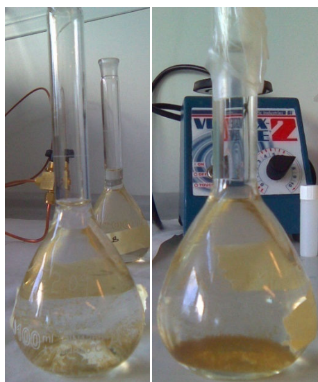
Figur 31. Udfældet humus efter 1 døgns henstilling af prøve, hvor pH < 2 .
