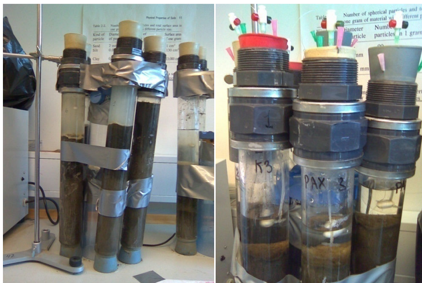
Figur 33. Intakte sedimentsøjler udtaget fra Nols sø til bestemmelse af frigivelsesraten af fosfat fra sedimentet. For at opnå en homogen fordeling i vandsøjlen er søjlerne spændt op omkring en magnetomrører og har hver en magnet hængende i en fiskesnøre fra den øverste prop. Prøverne opbevares ved stuetemperatur og dækket med sort plastik. Til venstre er billeder fra opstillingen, hvor den aerobe frigivelsesrate bestemmes. Ved denne opstilling er propperne sat løst på, for at forhindre fordampning fra søjlerne. Til højre er opstillingen til bestemmelse af den anaerobe frigivelsesrate. Her er der påmonteret nåle i propperne, som benyttes ved kvælstofgennembobling af vandsøjlen, samt tilsætning af natriumdithionit-opløsning og løbende udtag af vandprøver.
