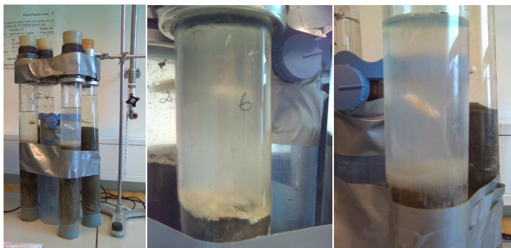
Figur 11. Intakte sedimentsøjler til bestemmelse af frigivelsesraten af fosfat efter der er tilsat enten Phoslock™, aluminiumklorid eller ingen af delene til søjlerne. Der er tilsat Phoslock™ på billedet i midten og aluminiumklorid på formen PAX-15 på billedet til højre. Der er konstant omrøring af vandsøjlen for at have en homogen opblending af vandsøjlen samt aerobe forhold. Propperne er sat løst på, for at forhindre fordampning fra søjlerne. Under hele forsøgsperioden opbevares prøverne ved stuetemperatur og i mørke vha. sorte plastiksække.
