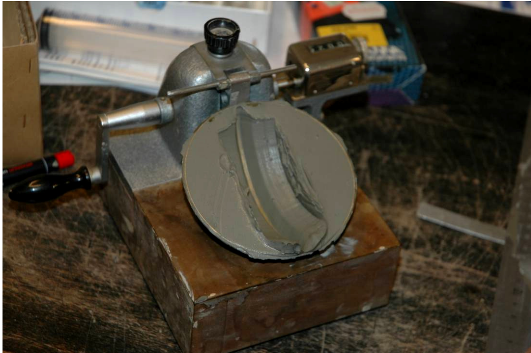
Figur 2: Casagrande apparat til bestemmelse af flydegrænsen.
