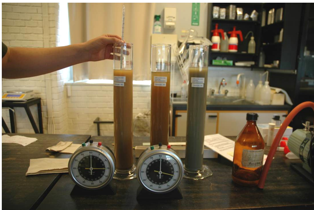
Figur 5: Hydrometeraflæsninge efter 24 timer
