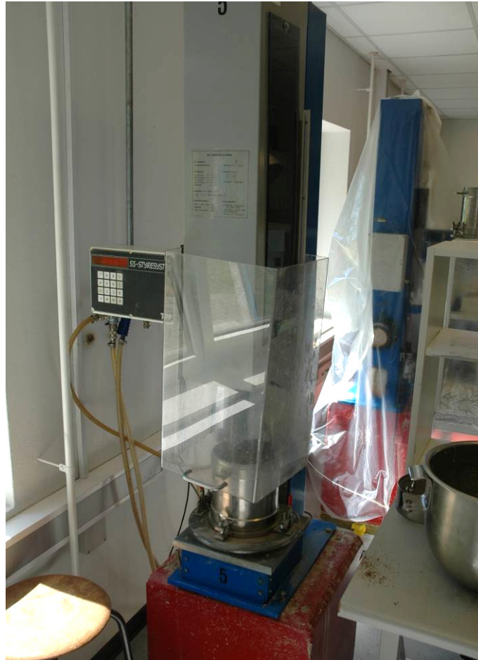
Figur 7: Stamper, stamper prøven 3 gange med 56 slag.
