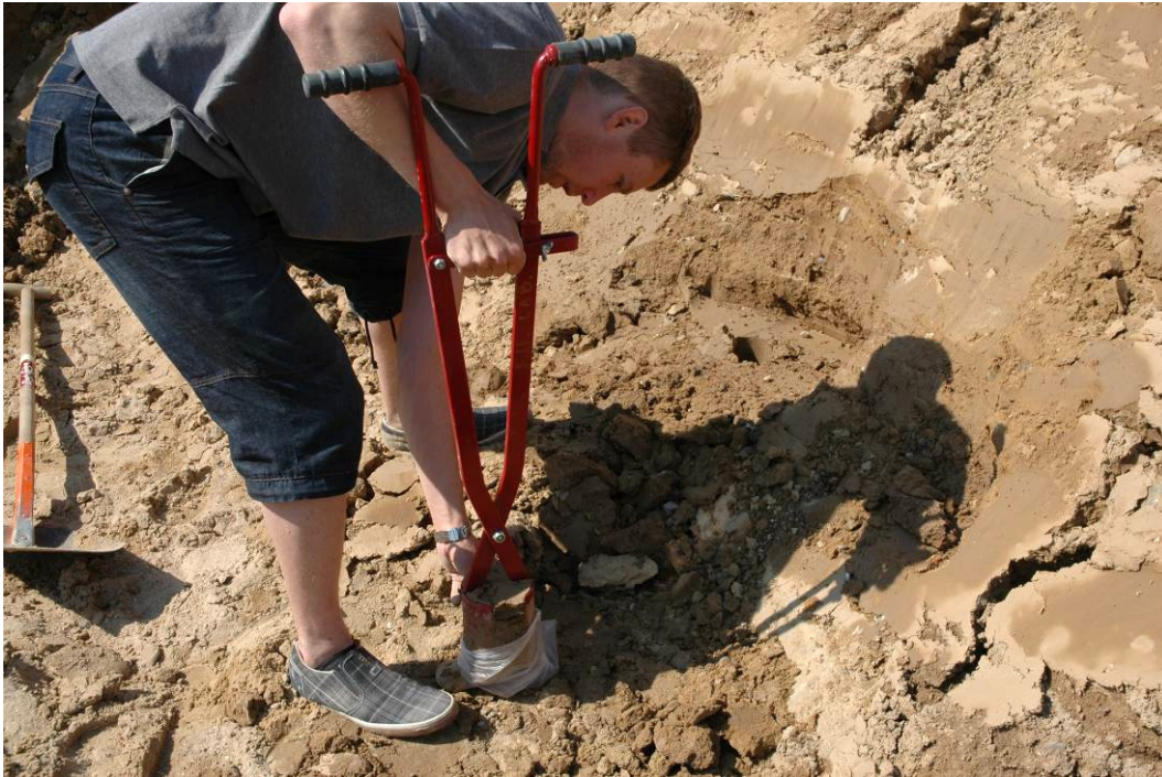
Figur 14: Udtagning af delprøve til klassificeringsforsøg
