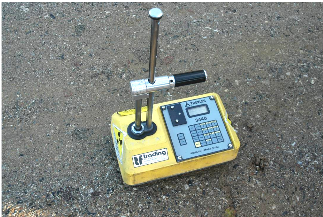
Figur 11. Bestemmelse af komprimeringsgraden ved brug af isotopmetoden.
