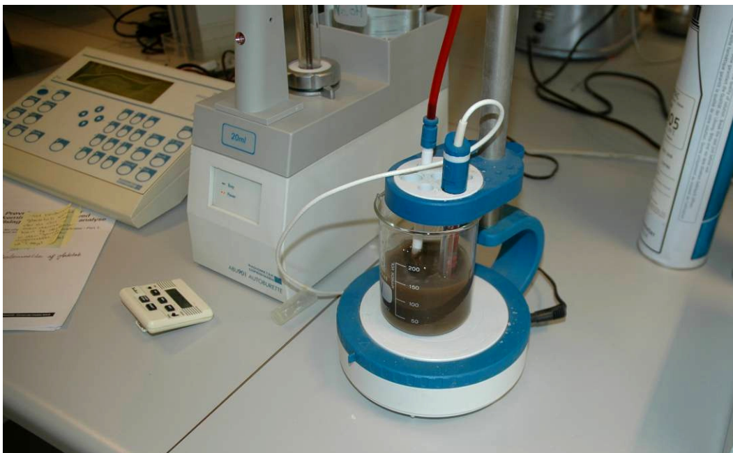
Figur 8: Autoburette som blander prøven med NaOH til en pH på 7.
