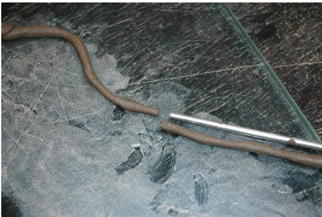
Figur 3: Lerprøven udrulles til 3,2 mm, uden at det bryder.
