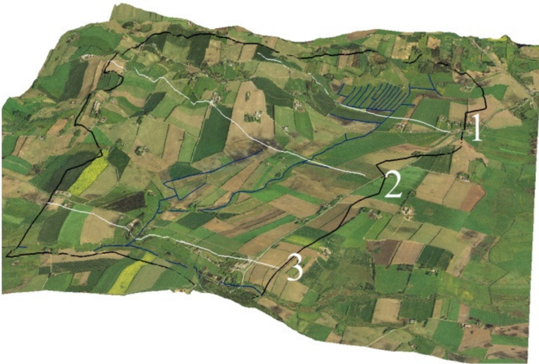
Figur 30: Draperet ortofoto for Oddebæk-området ved anvendelse af en digital højdemodel. Højden er overdrevet 3 gange i forhold til xy-planet.
