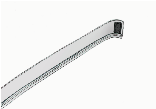
En skumklods limes fast i enderne for at lukke af for luftgennemstrømning, når modulerne er sat sammen.
