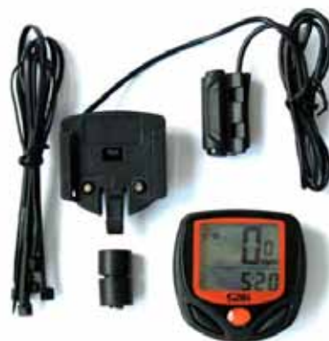
ill. 3.22.2 Almindelig cykelcomputer bruger en simpel og billig teknologi. Nyere sensorer sender data trådløst op til cykelcomputeren.
