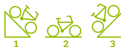
ill. 3.22.1 Med den samme hastighed giver disse 3 situationer meget forskellig intensitetsniveau. Deres hastighed alene repræsenterer ikke intensiteten. Derfor skal der integreres en højdemåler i sensoren.
