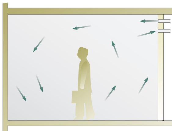
III.12 Ved opblandingsventilation blæses luften typisk ind ved loftet for at undgå trækgener. Den friske indblæste luft blandes her med den forurenede indeluft, hvorefter luften suges ud.
