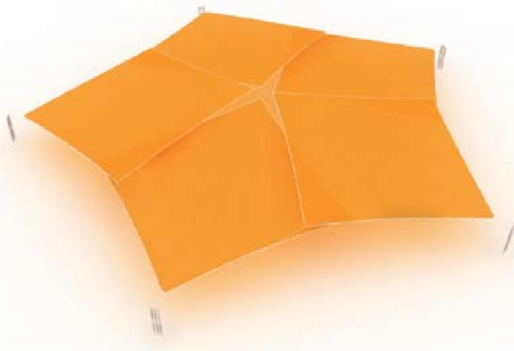
III.190 Det endelige design af tagfladen bestående af fem ens sejl, hvis dimensioner passer til containerens længde.
