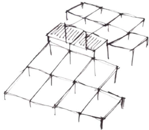
III.133 Ved at danne tagfladen ud fra flere sejl, som placeres i forlængelse af hinanden, bliver det muligt at dække det ønskede areal og variere dette fra placering til placering. Her bliver stængerne, som sejlene spændes ud mellem begrænsninger eller forhindringer for udformning af planen.
