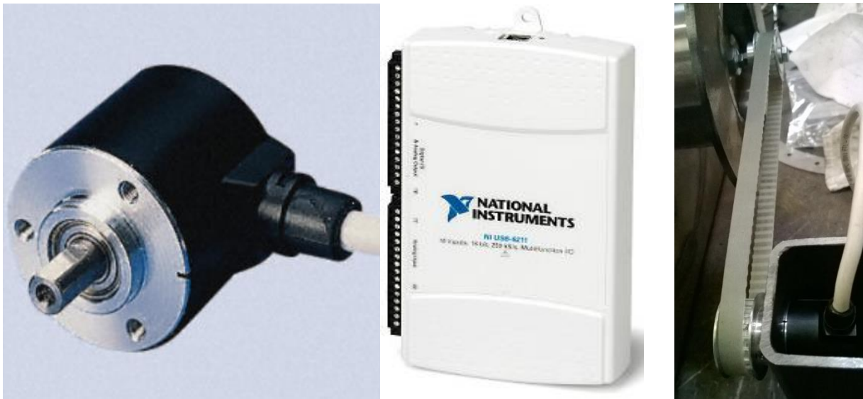
Figur 33 viser RI32 encoder til venstre, USD DAQ i midten og til højre remtrækket til encoderen. Remhjulene er ens så udvekslingen er 1:1
