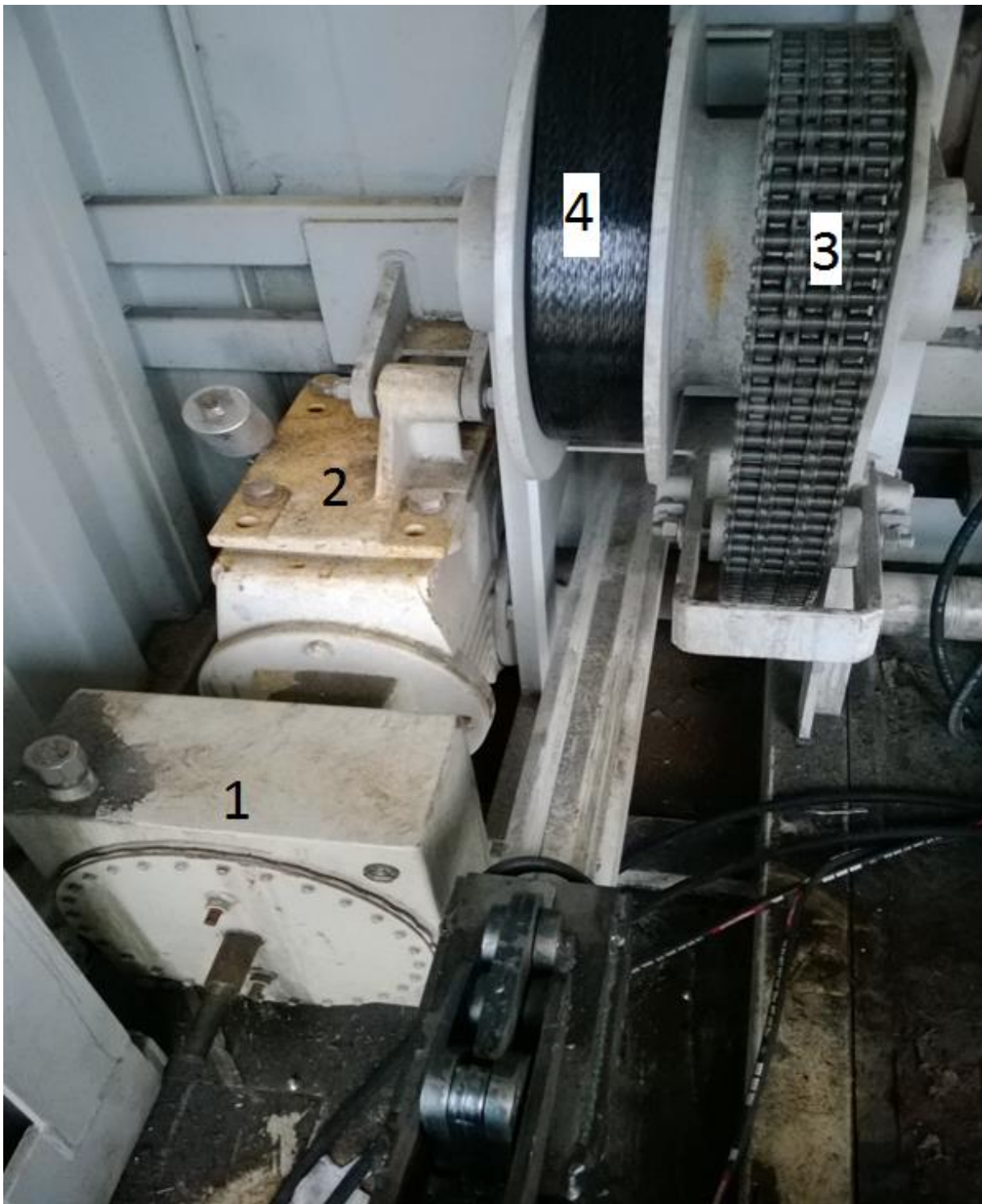
Figur 1 viser det bremsesystem Viking har anvendt hidtil. Viskosebremse forest [1], gearkasse bagved [2] og til højre kæde-tandhjulsudveksling [3]. Bemærk den sorte rem der trækkes i så systemet roterer [4].
