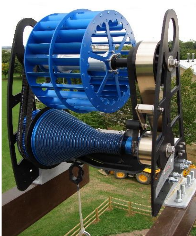
Figur 7 viser en Fan Decender som også er en viskosebremse, blot er det bremsende fluidum her luft [11]
