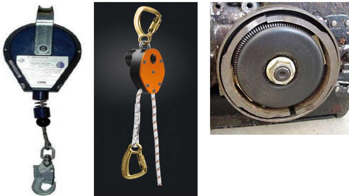
Figur 5 viser centrifugalkoblinger i forskellige anvendelser. Til venstre faldbremsen anvendt som sikkerhedsudstyr og til højre ses de indre dele af en centrifugalkobling [5][6][7]
