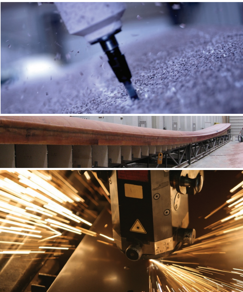
III. 53. Top, 5-akset fræser skærer form til vindmøllevinge; midte, halv form til vinge; bund, laser skæring af stålplade
