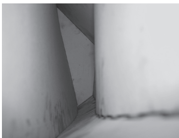
III. 64. Skalamodeller af støbeformene udført i 1:10 og 1:25. Formene skal underindeles til tre kamre, for at beton kan hældes i de to yderste kamre og isolering kan fyldes i det midterste kammer
