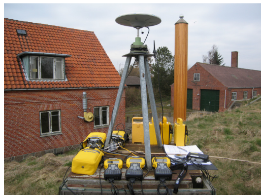
Fig. F3. Centrering over punkt 21 med optisk lod i et fastmonteret GPS-stativ. I baggrunden ses referencestationen i Buddinge.
