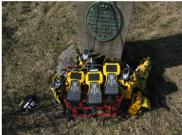
Fig. 25. Opstilling af de tre kontrollere, GNSS-modtagere, GSM-modems mm. foran postament.
