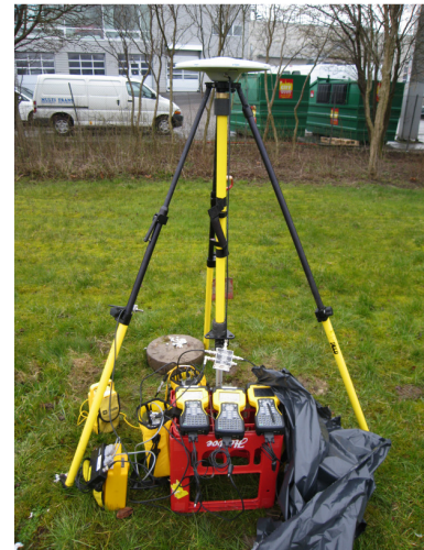
Fig. F5. Centrering over punkt 35 med Trimble snapstativ
