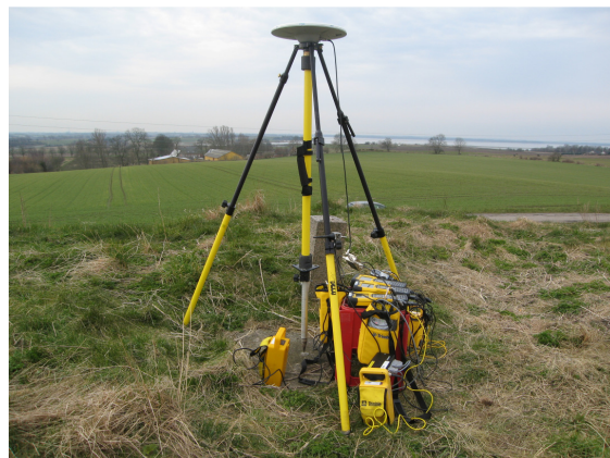
Fig. F9. Centrering i punkt 01 med et Trimble snap-stativ.
