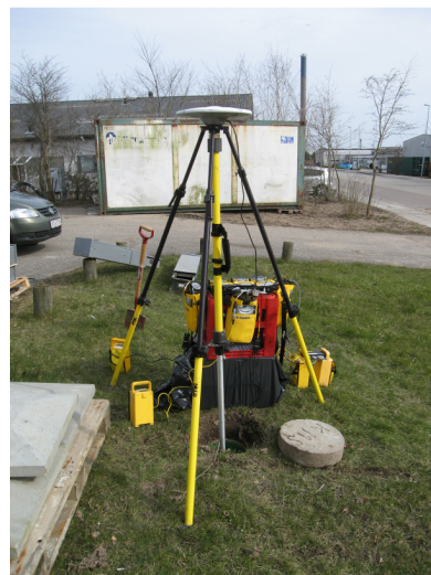
Fig. F7. Centrering i punkt 38 med et Trimble snapstativ
