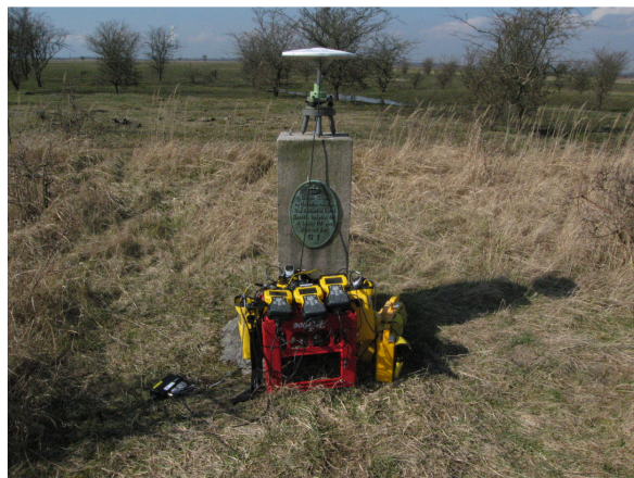
Fig. F11. Centrering i punkt 55 med malkeskammel med optisk centrering.
