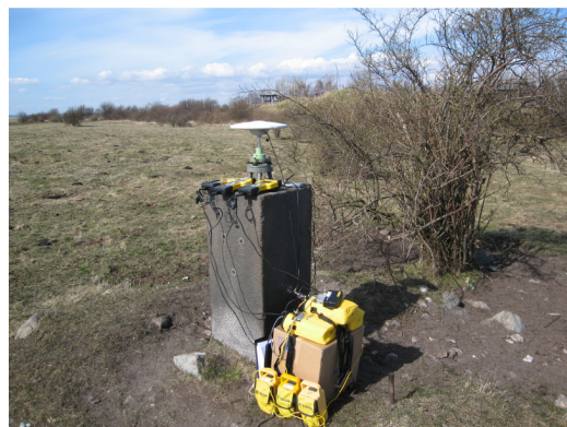
Fig. F1. Centrering over punkt 05 med malleskammel.
