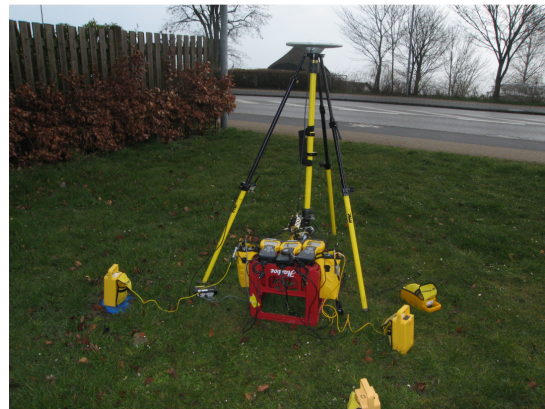
Fig. F13. Centrering i punkt "16" nær det rigtige punkt 16 med Trimble snapstativ.
