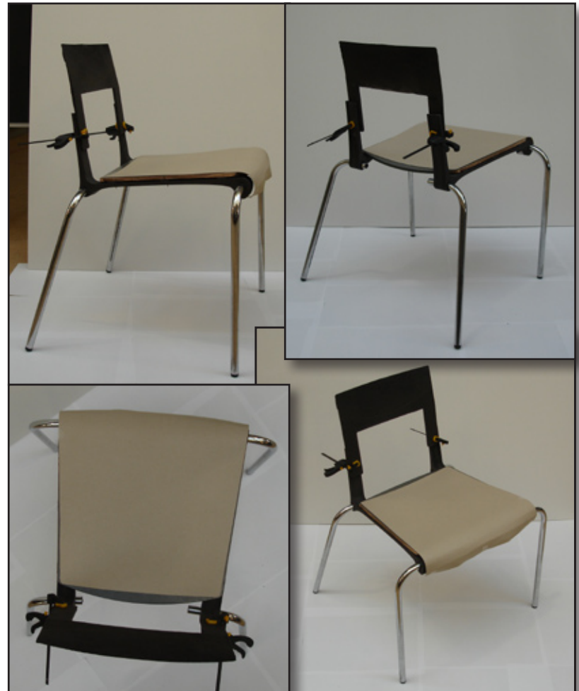
Ill. 71: 1:1 Mock-up af Ropes. Det eneste der afviger i 1:1 modellen fra det endelige design er benenes udformning. Disse er test ben.
