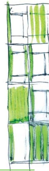
Transluente lameller. Lamelleren indstilles efter det ønskede dagslys i rummet
