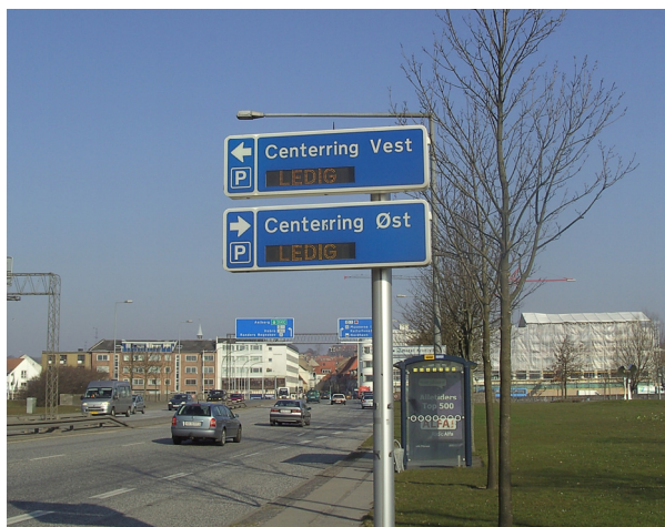
Figur 89. Tavletype 1 i Randers viser, om der findes ledige parkeringspladser for forskellige kørselsretninger på centerringen.
