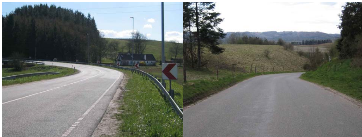
Figur 4.4 Venstre: Vejstrækning med skilte til at understrege en farlig traceret kurve. Højre: Vejstrækning uden skilte og med en farlig traceret kurve.
