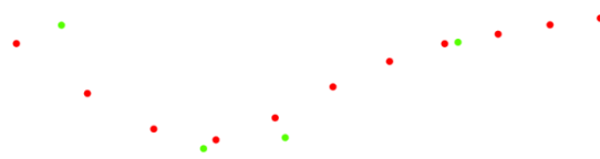
Figur 88 - Skæringsprofil B med procentafvigelse på 1 %. Grøn: skæringsprofil målt i marken. Rød: beregnede skæringsprofil.
