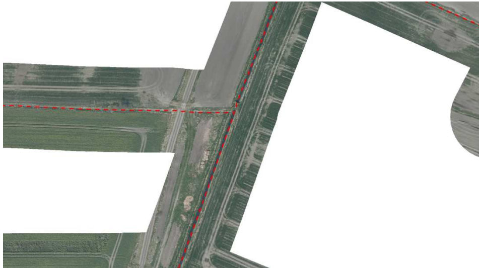
Figur 29 - Eksempel på foto beskåret ved hjælp af buffer ud fra FOT's vandløbsmidte. Stiplet rød: FOT's vandløbsmidte.
