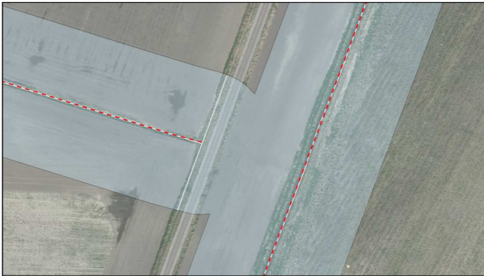
Figur 73 - Eksempel på et vandløbsforløb, der er identificeret, men som ikke findes i FOT. Lys grå: vandløbsmidte. Stiplet rød: FOT's vandløbsmidte. Lys blå: bufferzone.
