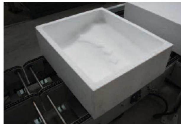
Støbeform i polystyren bearbejdet af robotten
