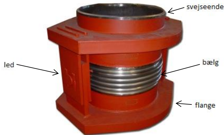
Figur 1.2 Angulær kompensator med lasker som led, og svejseender. [F2]
