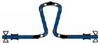
Figur 2.3: Ved forlængelse af de to vandrette rørstykker, udsættes systemet for vinkeldrejninger. [F3]
