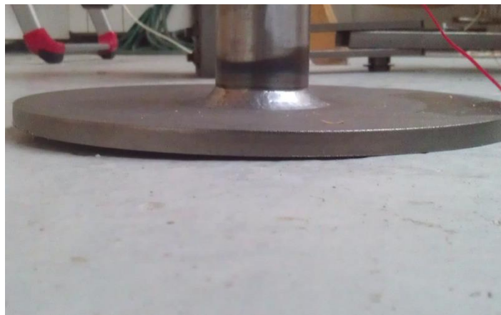
Figur 6.13: Deformation af bundpladen, grundet svejsning.
