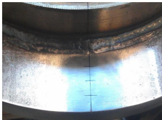
Figur 6.8: Konstruktionens overfladebeskaffenhed før strain gauges fastlimes.
