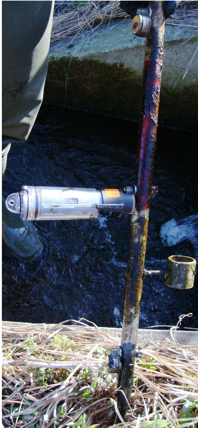
Figur 4.3: Logning af temperaturdata fra midterste logger, øverst og nederst ses en temperaturlogger
