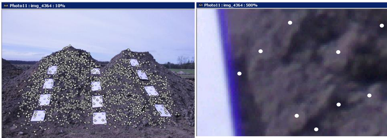
Figur A 2.5: Screenshot af et billede hvor der er fundet en række SmartPoints. Til højre er der zoomet ind, og det ses at SmartPoints ikke relaterer sig til bestemte objekter.
