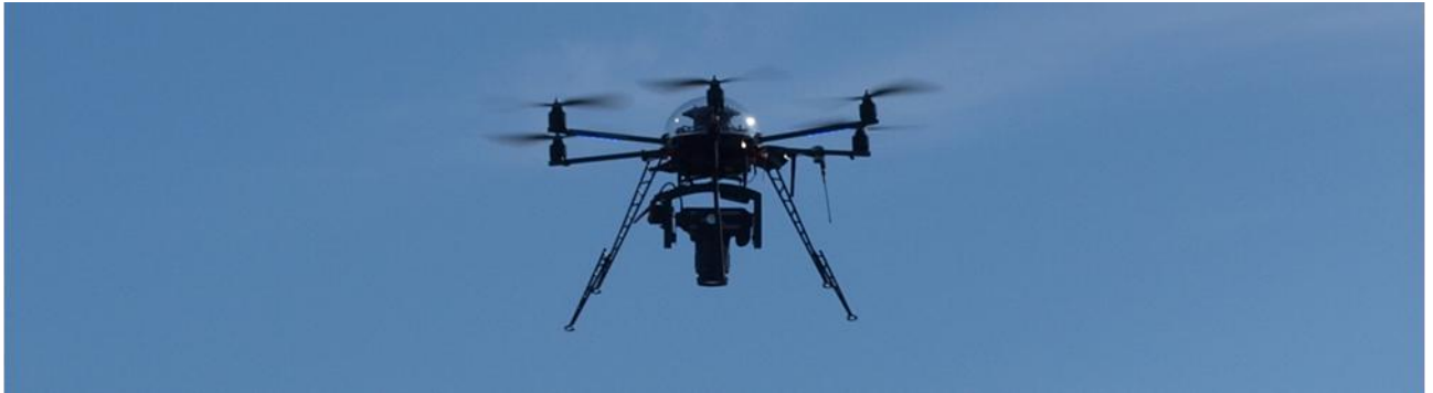
Ubemandet helikopter med digitalt spejlrefleks kamera
