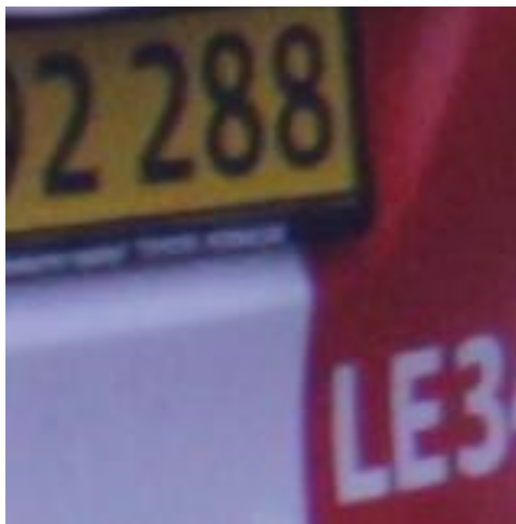
Figur 5.7: Udsnit af billeder hvor der er variation i ISO-værdien, hvor billedet til højre er mere grumset pga. af den høje ISO værdi.
