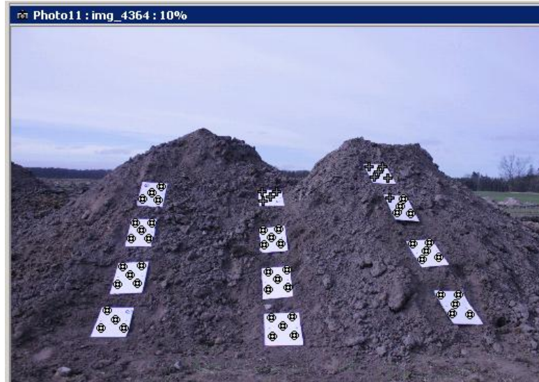
Figur A 2.4: Screenshot fra PhotoModeler der viser antallet af genfundne punkter efter anvendelse af automatisk genfindning af RAD-punkter på billeder, hvor der er justeret på farverne. Næsten alle RAD-punkter er fundet.
