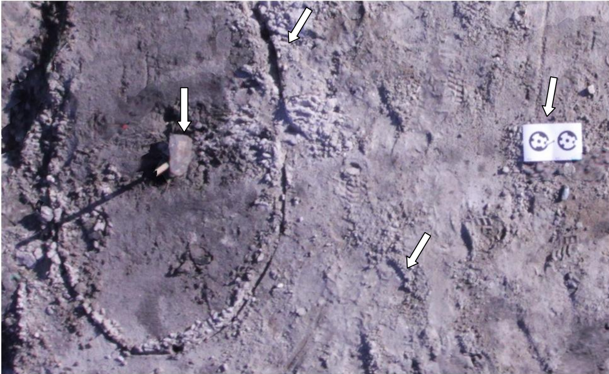
Figur 13.2: Udsnit af ortofoto optaget med 10 mm brændvidde i 4 m højde.
