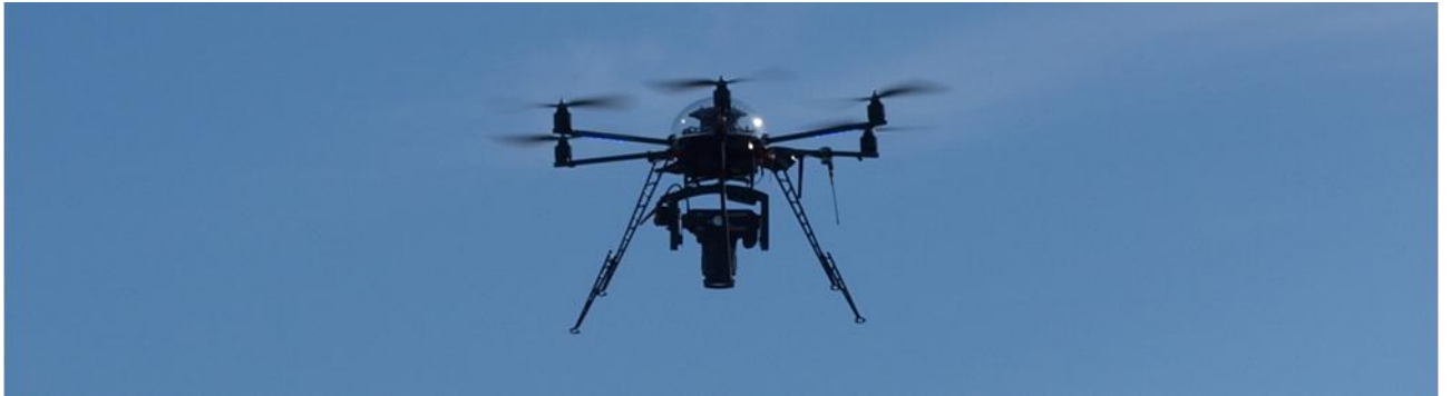
Ubemandet helikopter med digitalt spejlrefleks kamera
