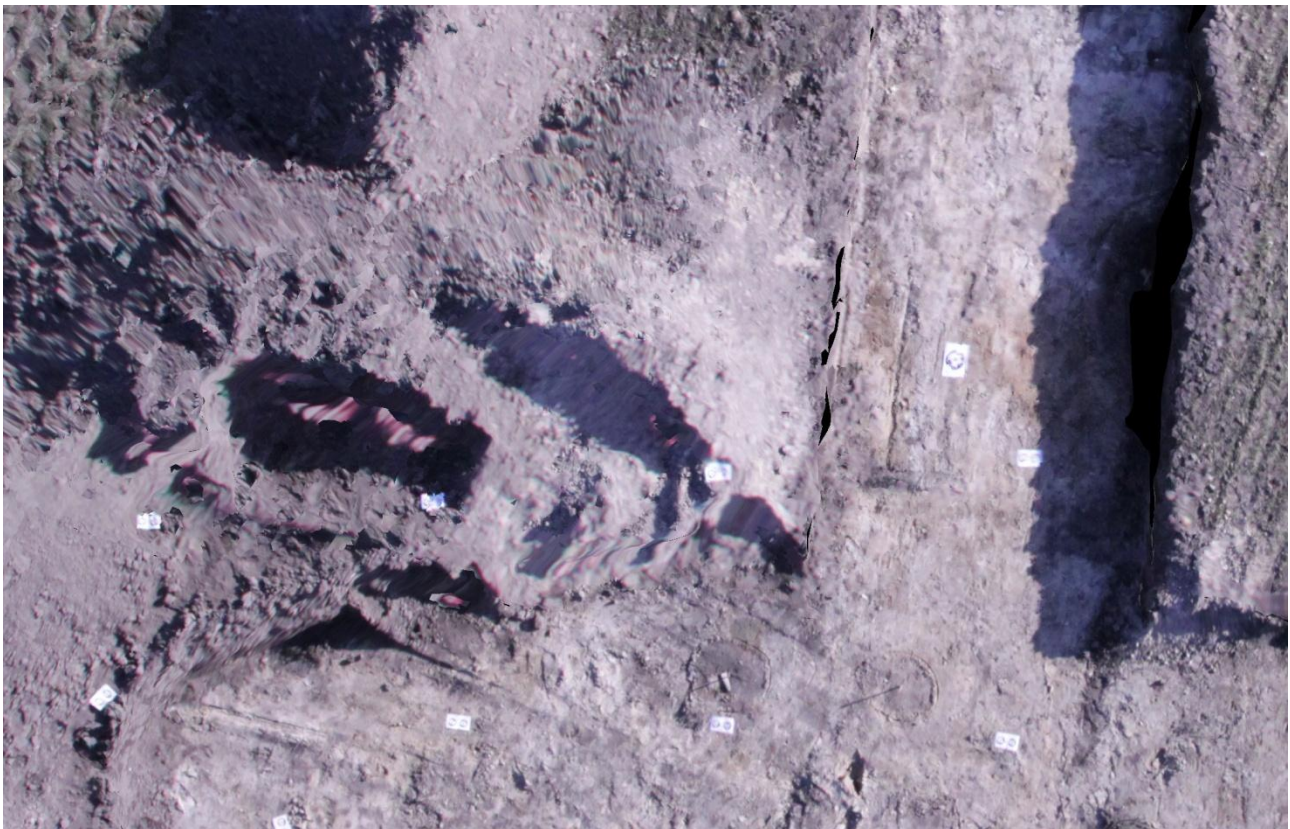
Figur A 6.2: Udsnit af ortofoto fra serie 5 optaget med 10 mm brændvidde i 15 m flyvehøjde. Eksemplet viser et sted, hvor der er forskellige terrænhøjder og hvor farvningen af pixelerne har betydet, at jordbunken er forstrukket.
