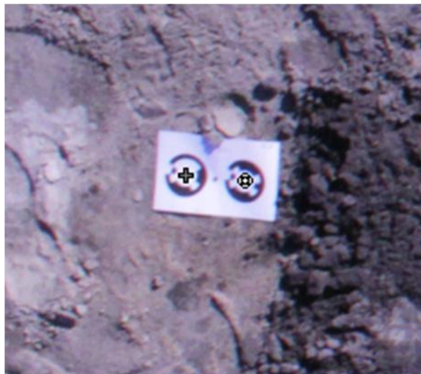
Figur 7.1: Her har PhotoModeler automatisk målt to RAD-punkter. Det venstre RAD-punkt er fundet, men er hverken blevet afkodet eller refereret. Punktets grå farve signalerer, at det ikke er refereret. RAD-punktet til højre er både blevet afkodet og refereret, hvor punktets hvide farve signalerer, at det er refereret.
