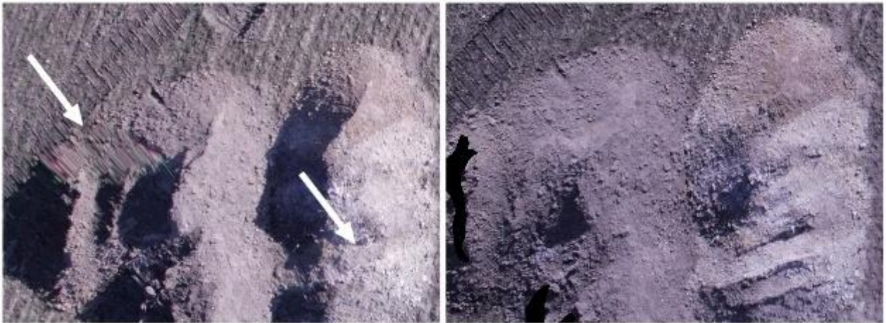
Figur 6.2: Til venstre ses et udsnit af et ortofoto lavet ud fra billeder taget med 10 mm brændvidde og til højre ses et tilsvarende udsnit fra et ortofoto lavet ud fra billeder taget med 18 mm brændvidde. De hvide pile markerer steder, hvor forvrængningen er stor, som følge af at der er fløjet i lav højde med lille brændvidde over et område med relativt høje objekter. Forvrængningen i billederne taget med større brændvidde fra større højde er væsentlig mindre.
