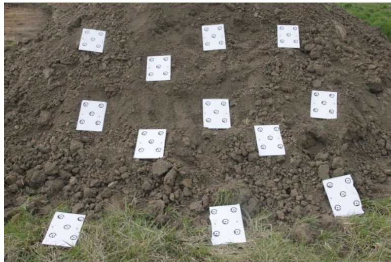
Figur 9.1: Kalibreringsark placeret på en jordvold i marken under 2. flyvning, klar til at blive fotograferet, så kameraet senere kan blive kalibreret. Billederne er taget af en person der står på jorden.
