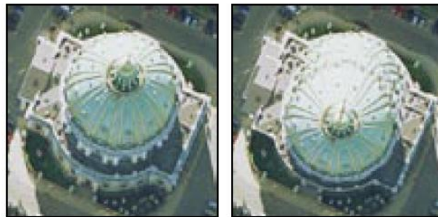
Figur C 1.3: Marmorkirken i København. Til venstre ses et normalt ortofoto dannet på baggrund af en DTM, der resulterer i, at bygningen vælter en smule. Til højre er der anvendt en overflademodel, der dermed udgør den omtalte spøgelses effekt. (Buch, 2005)
