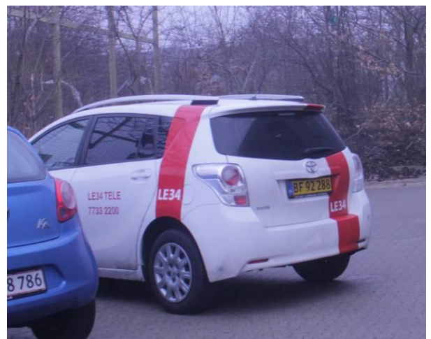
Figur 5.2: Eksempel på varierende lukkertid, hvor der er optaget billeder mens kameraet har været i bevægelse.
