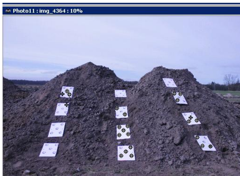
Figur A 2.2: Screenshot fra PhotoModeler der viser antallet af genfundne punkter efter anvendelse af automatisk genfindning af RAD-punkter. Kun et få antal punkter er blevet fundet.
