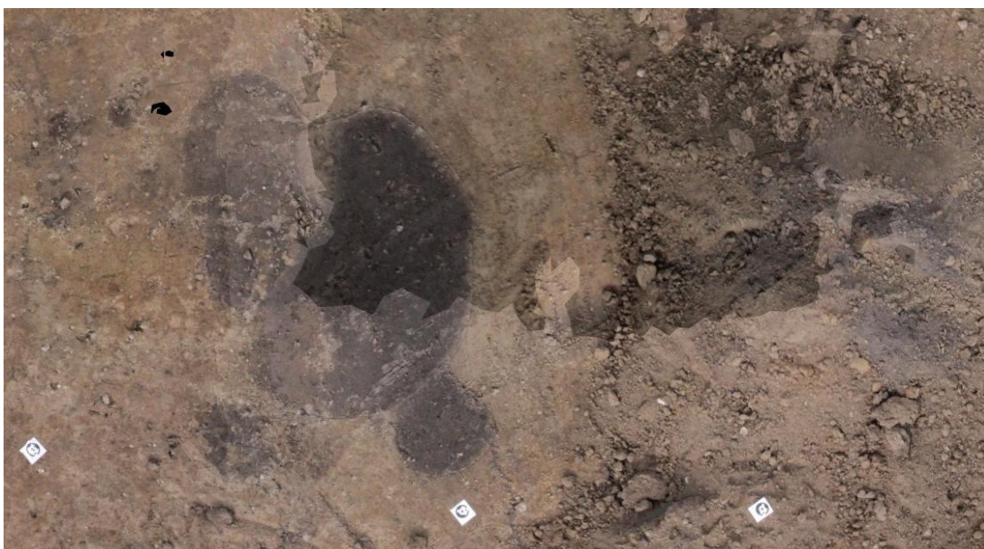
Figur 13.5: Udsnit af ortofoto på baggrund af serie 10 med 24mm brændvidde i 17m højde. Der ses en kantete linje gennem billedet mellem brunlige farver og mere støvede og lysere brunlige farver. Dette er tilsyneladende grænsen mellem forskelligt billedmateriale.
