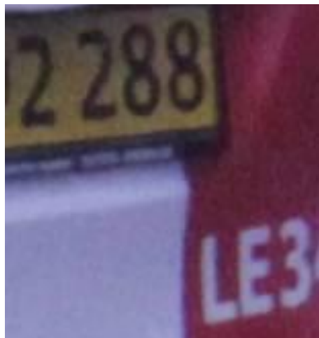
Figur 5.7: Udsnit af billeder hvor der er variation i ISO-værdien, hvor billedet til højre er mere grumset pga. af den høje ISO værdi.
