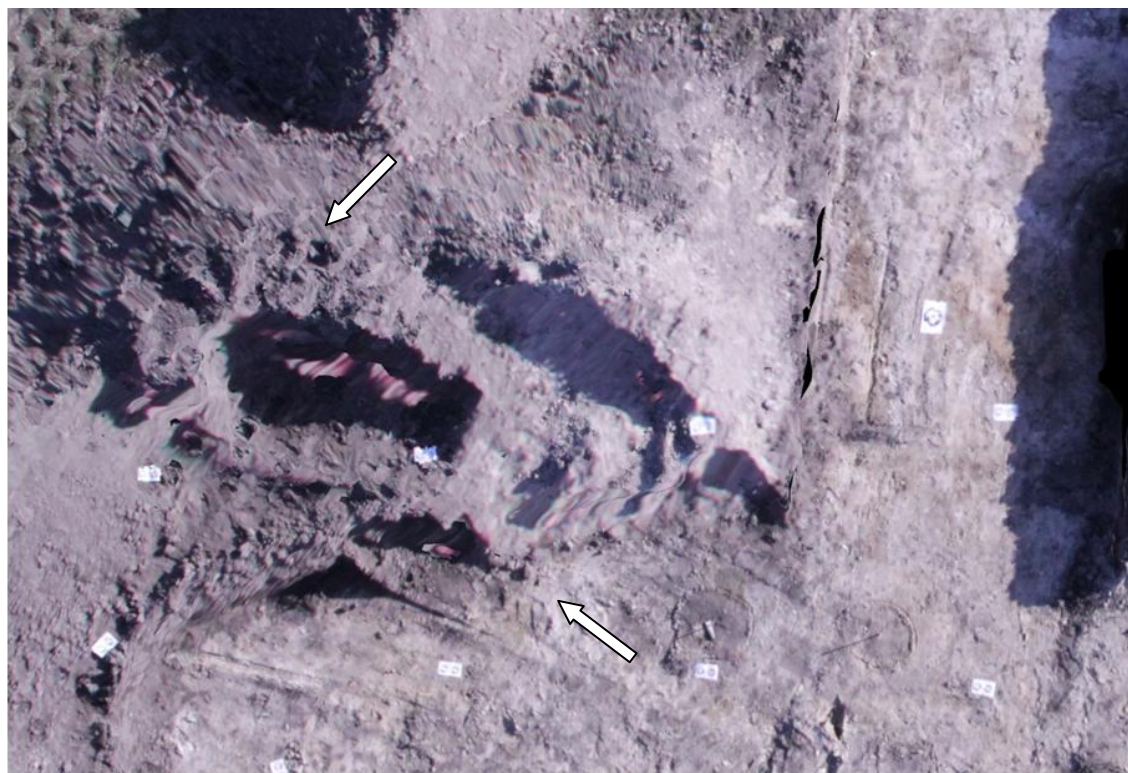
Figur 13.4: Udsnit af ortofoto optaget med 10mm brændvidde i 15 m højde. Eksemplet viser et sted, hvor der er forskellige højder, og hvor resamplingen ikke er gået så godt, fordi pixelværdierne til jordbunken er tværet ud.
