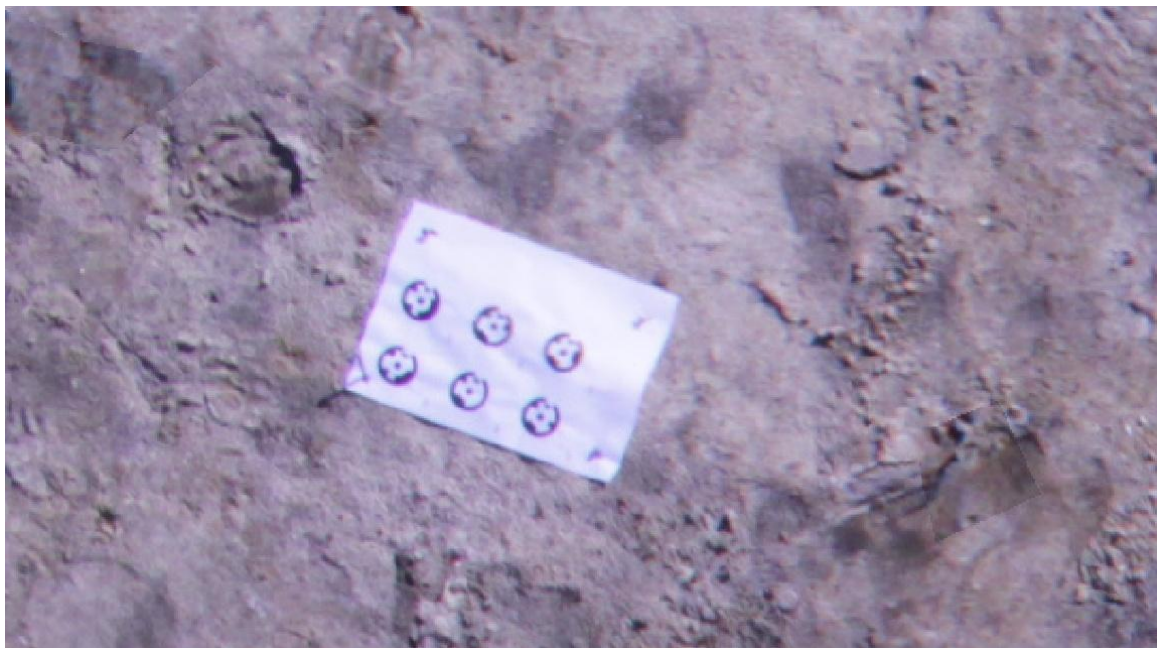
Figur A 6.13: Udsnit af ortofoto fra serie 3 optaget med 18 mm brændvidde i 6 m flyvehøjde. Udsnit af et A4-ark med seks RAD-punkter på. Billedet er sammenligneligt med figur A 6.11 fra serie 4
