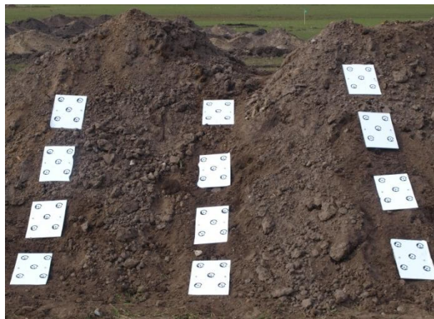
Figur A 2.1: Eksempel på et kalibreringsbillede, hvor alle 12 kalibreringsark kan ses.
