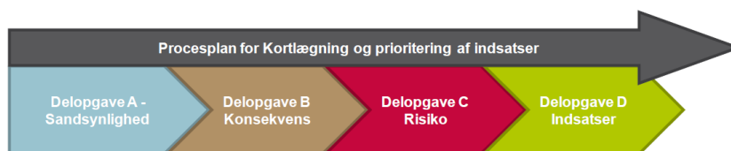
Figur 2: Arbejdsprocessen i forbindelse med planlægning af håndteringen af ekstremregn - som er en del af Roskilde Kommunes klimatilpasningsstrategi. Arbejdsprocessen indeholder fire delprocesser: A - sandsynligheden for oversvømmelser som følge af ekstremregn, B - konsekvensen ved oversvømmelserne, C - et samlet billede af risikoen ved oversvømmelser og D - planlægningen og prioritering af indsatser mod oversvømmelser (Orbicon, 2012b).
